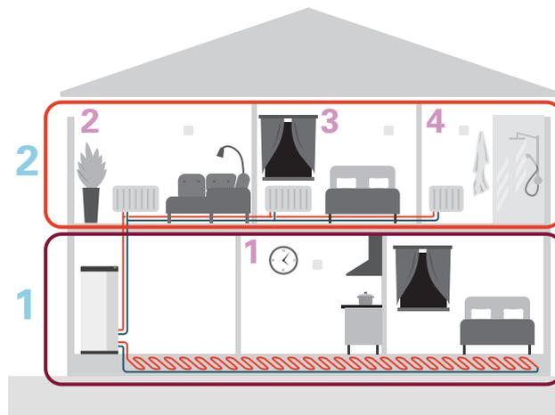
Cet exemple montre une habitation comprenant deux circuits de distribution (1 et 2, sur deux étages différents) divisés en quatre zones (1-4, quatre pièces différentes). La température et la ventilation contrôlée à la demande peuvent être commandées individuellement pour chaque zone (accessoire requis).
