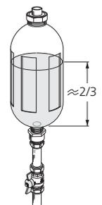
Pour augmenter la pression du système, fermez la soupape du circuit sortant principal lorsque la pompe à eau glycolée ((GP2)) est activée et que la cuve de niveau ((CM2)) est ouverte, de sorte que le liquide s'en échappe.
