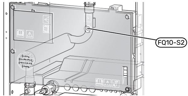
Le limiteur de température (FQ10) coupe l'alimentation électrique de l'appoint électrique supplémentaire si la température dépasse 89 °C. Il doit être réinitialisé manuellement.
