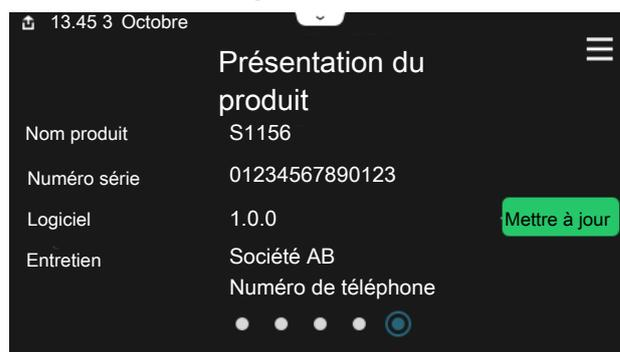
Vous pouvez rechercher ici des informations sur le nom du produit, le numéro de série du produit, la version du logiciel et l'entretien. Les nouvelles versions du logiciel peuvent être téléchargées ici (si S1156 est connecté à myUplink).
