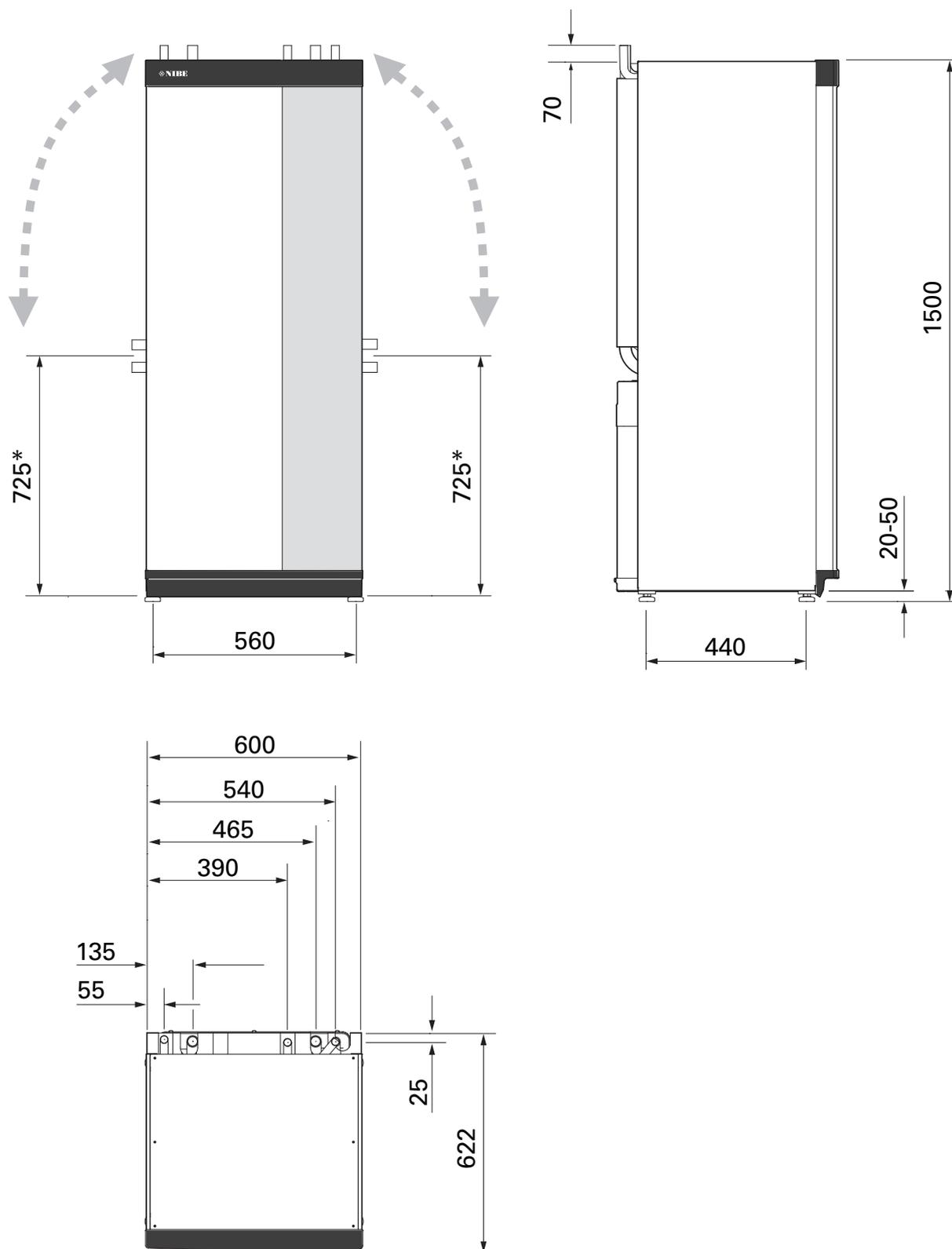
\* Cette dimension s'applique selon un angle de 90° sur les tuyaux à eau glycolée (raccordement latéral). Elle peut varier d'environ  $\pm 100$  mm en hauteur, car les tuyaux à eau glycolée sont partiellement flexibles.
