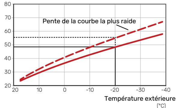
La pente de courbe optimale dépend des conditions climatiques, de la température extérieure de base (TEB) la plus basse de votre région, ainsi que de l'équipement de votre habitation (radiateurs, ventilo-convecteurs ou plancher chauffant) et de sa qualité d'isolation.
