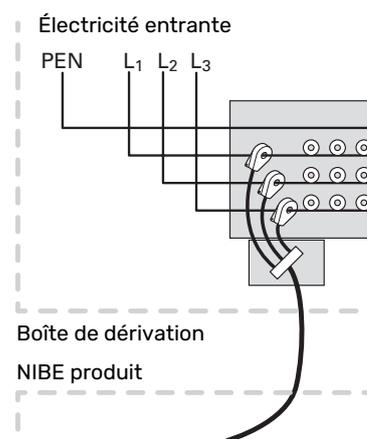
3. Raccordez la sonde au bornier AA100-X14:BE1-BE3 et à un bornier de AA100-X13:GND.
