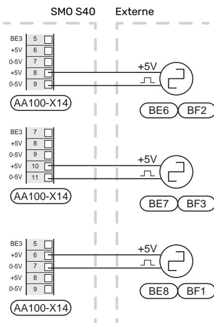
Activez le(s) compteur(s) dans le menu 7.2 – « Réglages accessoires », puis définissez la valeur souhaitée (« Énergie par imp. » ou « Impuls. par kWh ») dans le menu 7.2.19 – « Compt. énergie impulsion ».
