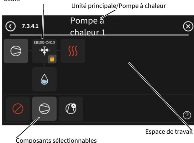
*Unité principale/Pompe à chaleur* : Sélectionnez ici la pompe à chaleur pour laquelle le réglage du raccordement doit être effectué (s'il n'y a qu'une seule pompe à chaleur dans le système, seule l'unité principale est affichée).
