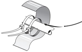
Les sondes de température sont montées à l'aide d'une pâte conductrice, de serre-câbles (le premier étant fixé au tuyau au milieu de la sonde et l'autre monté à environ 5 cm après la sonde) et de ruban d'aluminium. Isolez-les ensuite à l'aide du ruban isolant fourni.
