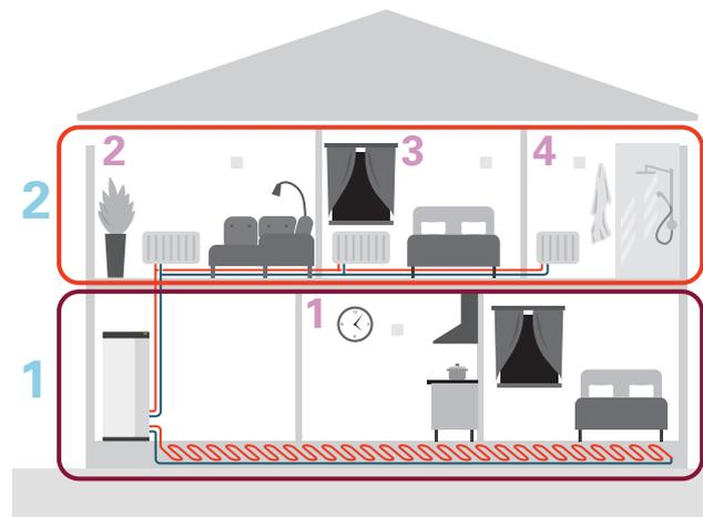
Cet exemple montre une habitation comprenant deux circuits de distribution (1 et 2, sur deux étages différents) divisés en quatre zones (1-4, quatre pièces différentes). La température peut être régulée individuellement dans chaque zone (un accessoire est nécessaire).
