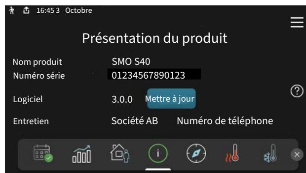
Vous pouvez rechercher ici des informations sur le nom du produit, le numéro de série du produit, la version du logiciel et l'entretien. Les nouvelles versions du logiciel peuvent être téléchargées ici (si SMO S40 est connecté à myUplink).
