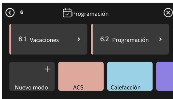
Seleccione los ajustes que va a incluir el modo. Arrastre con el dedo hacia la izquierda para seleccionar el nombre y el color del modo para que sea único y diferenciarlo de otros modos.
