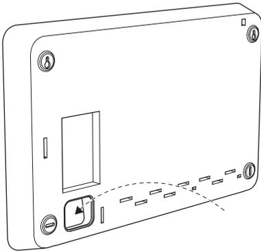
3. Desplace la pantalla hacia la izquierda para extraerla. Separe el cable del extremo inferior
