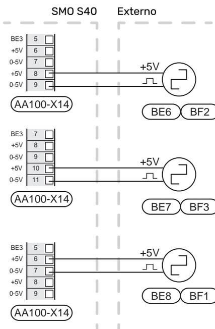
Active los contadores en el menú 7.2 - «Config. accesorios» y ajuste el valor deseado («Energ. por impul.» o «Impulsos por kWh») en el menú 7.2.19 - «Pulsos cont energía».
