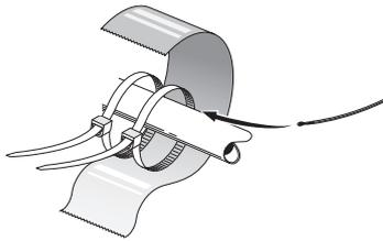
Para montar los sensores de temperatura, utilice pasta termoconductora, sujetacables (coloque el primero en la tubería por el centro del sensor y el otro unos 5 cm detrás del sensor) y cinta de aluminio. A continuación, aíselos con la cinta aislante suministrada.
