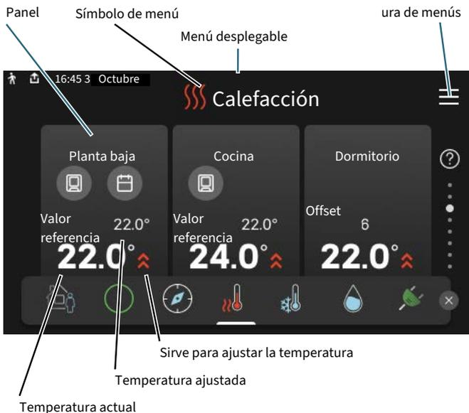
Pulse la tarjeta para ajustar el valor deseado. En determinadas páginas de función tendrá que arrastrar hacia arriba o hacia abajo con el dedo para ver más paneles.
