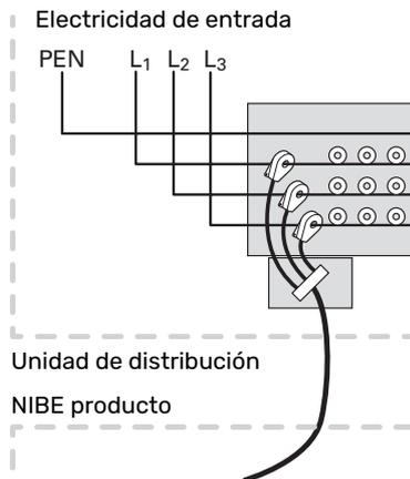
3. Conecte el sensor al bloque de terminales AA100-X14:BE1-BE3 y a cualquier bloque de terminales AA100-X13:GND.
