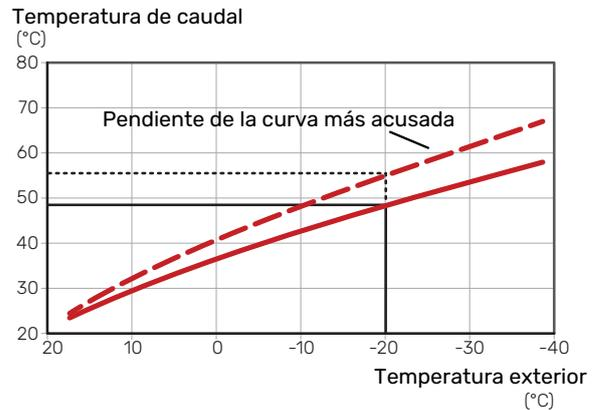
La pendiente óptima de la curva dependerá de las condiciones climatológicas y la temperatura exterior dimensionada mínima (TED) de su localidad, del tipo de calefacción (suelo radiante, aerotermos o radiadores) y de la calidad del aislamiento de la vivienda.
