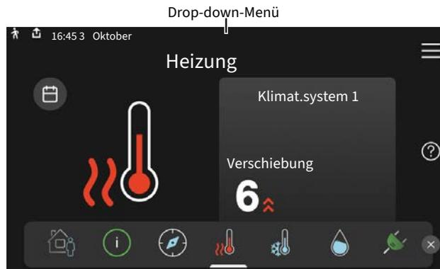
Das Drop-down-Menü zeigt den aktuellen Status von SMO S40, welche Teile in Betrieb sind und was SMO S40 derzeit ausführt. Die derzeit in Betrieb befindlichen Funktionen werden mittels eines Rahmens markiert
