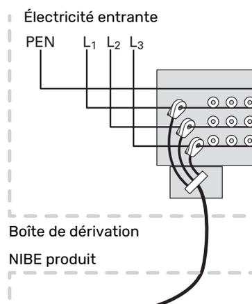
3. Raccordez le câble au bornier AA2-X30:9-12, où X30:9 est le bornier commun pour les trois capteurs d'intensité.
