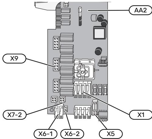
La tension de commande (230 V ~ 50Hz) se raccorde à AA2:X5:N, X5:L et à X6-2 (PE).
