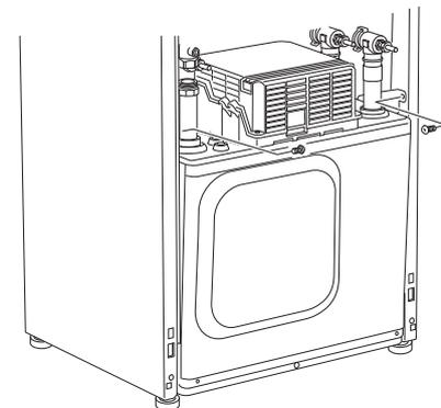
6. Débranchez les raccords (XF2), (XF11) et (XF22).
