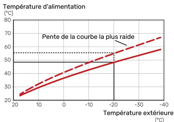
La pente de courbe optimale dépend des conditions climatiques, de la température extérieure de base (TEB) la plus basse de votre région, ainsi que de l'équipement de votre habitation (radiateurs, ventilo-convecteurs ou plancher chauffant) et de sa qualité d'isolation.
