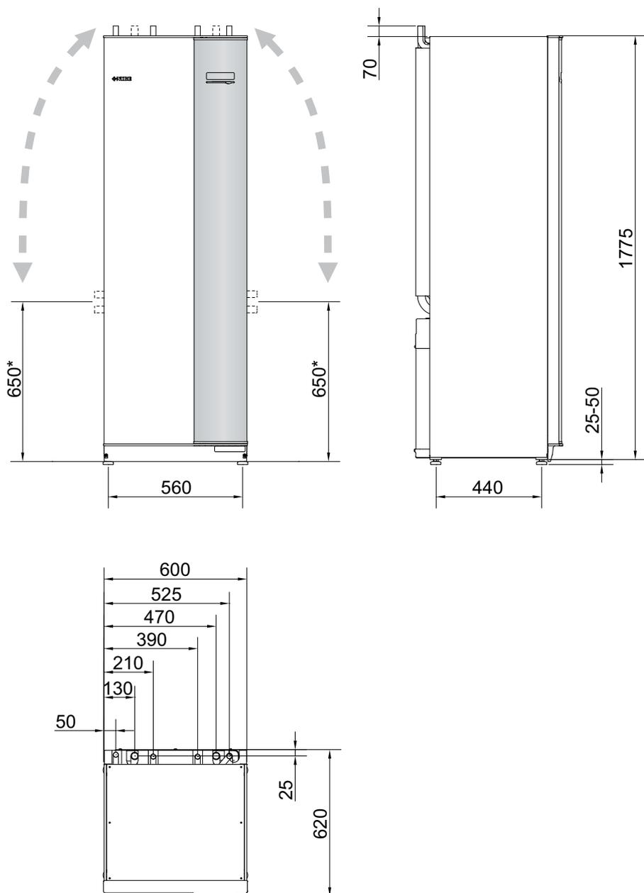
\* Cette dimension s'applique selon un angle de 90° sur les tuyaux à eau glycolée (raccordement latéral). Elle peut varier d'environ  $\pm 100$  mm en hauteur, car les tuyaux à eau glycolée sont partiellement flexibles.
