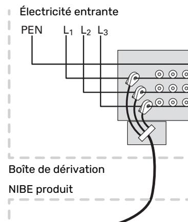
3. Branchez le câble à la platine d'entrée (AA3) sur le bornier X4:1-4, où X4:1 correspond au bornier commun aux trois capteurs d'intensité.
