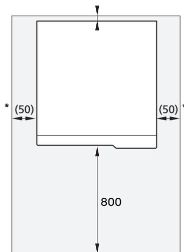
\* Une installation normale requiert 300 à 400 mm (de chaque côté) pour le raccordement d'équipements tels que la cuve de niveau, les vannes ou tout équipement électrique.
