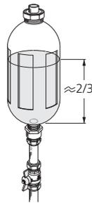
Pour augmenter la pression du système, fermez la soupape du circuit sortant principal lorsque la pompe à eau glycolée ((GP2)) est activée et que la cuve de niveau ((CM2)) est ouverte, de sorte que le liquide s'en échappe.
