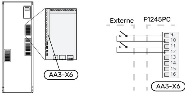
L'exemple ci-dessus utilise les entrées AUX1 (X6:9-10) et AUX2 (X6:11-12) de la platine d'entrée (AA3).
