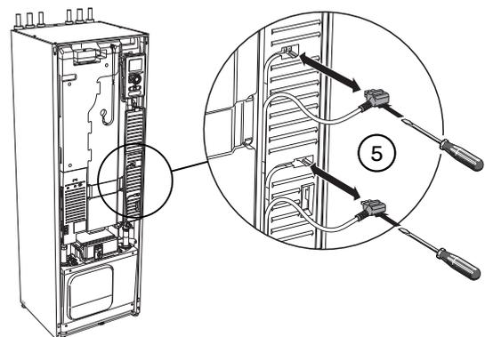
7. Déconnectez les commutateurs (A), (B) et (E) du dessous de l'armoire de la carte électronique.
