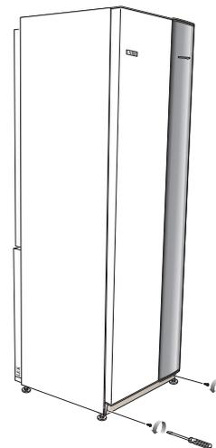
2. Soulevez le panneau au niveau du bord inférieur pour le déposer.
