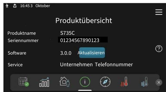
Hier finden Sie Angaben wie die Produktbezeichnung, die Seriennummer des Produkts, die Version der Software und den Service. Eventuelle Software kann hier heruntergeladen werden (sofern S735C mit myUplink verbunden ist).
