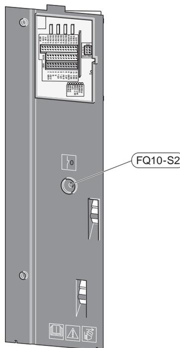
Der Sicherheitstemperaturbegrenzer (FQ10) unterbricht die Spannungszufuhr zur elektrischen Zusatzheizung, wenn die Temperatur 89 °C überschreitet. Der Sicherheitstemperaturbegrenzer wird manuell zurückgesetzt.
