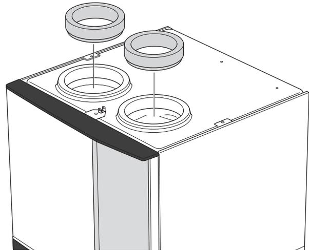
Verbinden Sie die Wärmepumpe mit dem Kanalsystem über Nippel (nicht im Lieferumfang enthalten) oder andere Lüftungselemente in den Lüftungsanschlüssen.
