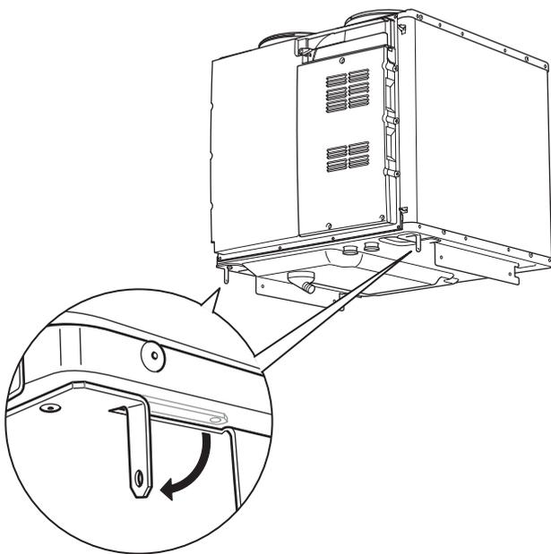
4. Platzieren Sie das Abluftmodul auf dem Speicherteil, indem Sie den hinteren Teil des Abluftmoduls in den Speicherteil einpassen.
