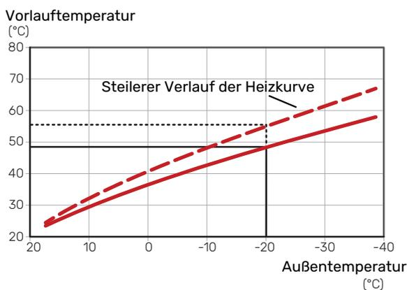
Der optimale Kurvenverlauf hängt von den lokalen Klimabedingungen und der kleinsten Normaußenlufttemperatur (NAT) ab sowie davon, ob das Haus Heizkörper, Gebläsekonvektoren oder Fußbodenheizung hat und wie gut es isoliert ist.
