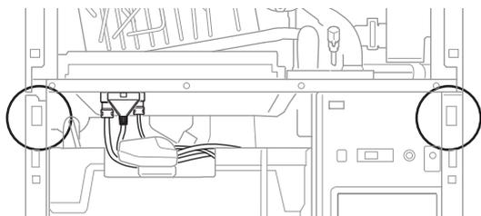
13. Montieren Sie die Verkleidungen am Abluftmodul sowie am Speicherteil.
