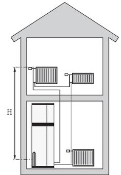
Ist der Vordruck nicht ausreichend, kann dieser durch Nachfüllen von Luft durch das Ventil des Ausdehnungsgefäßes erhöht werden. Eine Änderung des Vordrucks beeinflusst die Fähigkeit des Ausdehnungsgefäßes, eine Wasserausdehnung aufzunehmen.
