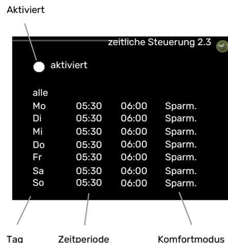
Hier können Sie zeitlich steuern, mit welchem Brauchwasserkomfort die Wärmepumpe betrieben werden soll.
