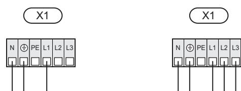
La instalare, montați conexiunea cu șuruburi în partea din spate a pompei de căldură. Partea conexiunii cu șuruburi care tensionează cablul trebuie să fie strânsă la un cuplu de torsion de peste 3,5Nm.
