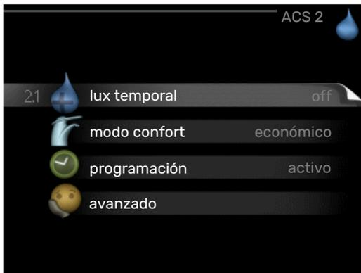
Este menú sólo se muestra si hay un acumulador de ACS acoplado a la bomba de calor.
