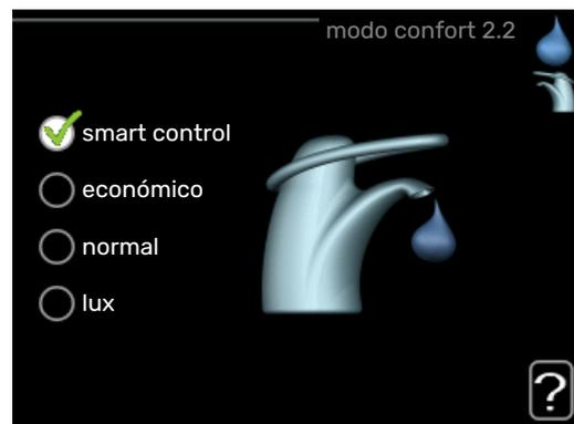
La diferencia entre los distintos modos es la temperatura del agua que sale del grifo de agua caliente. A mayor temperatura, más dura el agua caliente.
