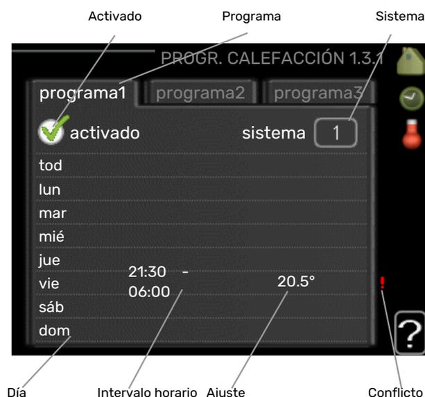
Aquí puede programar un aumento o disminución de la temperatura interior para hasta tres intervalos horarios al día. Si hay un sensor de habitación instalado y activado, la temperatura interior deseada (°C) se ajusta durante ese intervalo de tiempo. Si no hay un sensor de habitación activado, se configura el cambio deseado (del ajuste en el menú
