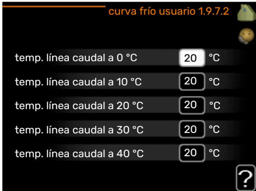
Cree aquí una curva de calor o de refrigeración propia, si tiene requisitos especiales, definiendo las temperaturas de caudal deseadas para distintas temperaturas exteriores.
