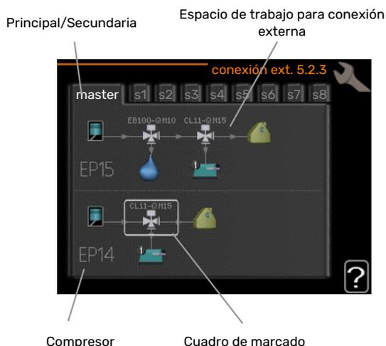
**Master/esclava:** Permite seleccionar a qué bomba de calor se aplicará la configuración de acoplamiento (si solo hay una bomba de calor, solo se mostrará la master).
