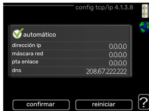
Aquí se define la configuración TCP/IP de la instalación.
