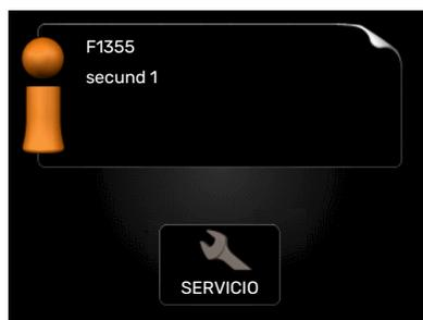
Si configura la bomba de calor como unidad secundaria se muestra un menú principal limitado, porque la mayoría de los ajustes del sistema se configuran en la bomba de calor principal.
