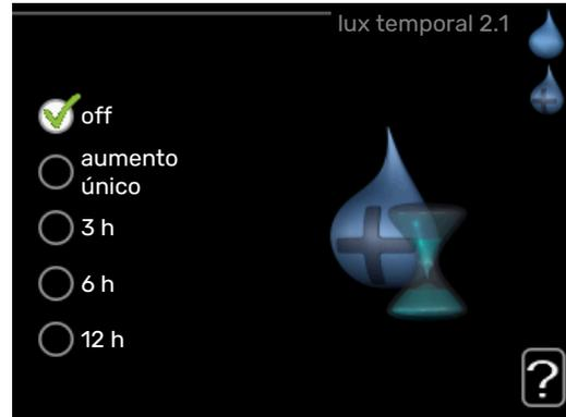
Si la necesidad de agua caliente aumenta temporalmente, se puede usar este menú para seleccionar un aumento de la temperatura del agua caliente configurando el modo lux durante un periodo de tiempo seleccionable.
