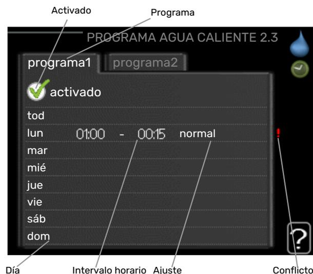
En este menú se define el modo de confort del ACS con el que debe trabajar la bomba de calor para hasta dos intervalos horarios diferentes al día.
