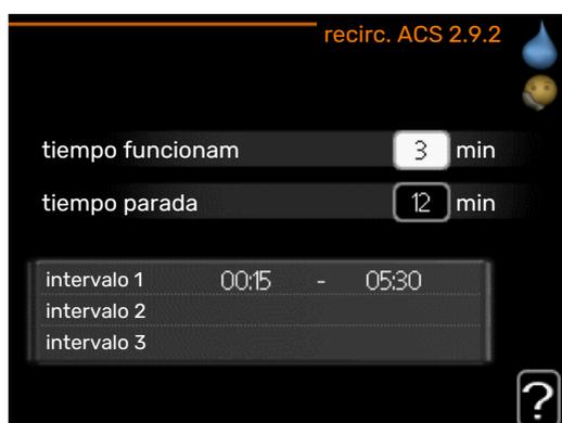
Define la circulación de agua caliente para hasta tres intervalos horarios al día. Durante los intervalos definidos, la bomba de circulación de agua caliente trabajará con arreglo a la configuración establecida.
