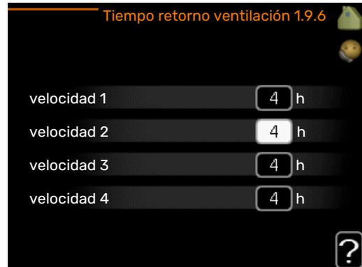
Aquí se selecciona el tiempo de retorno del cambio de velocidad temporal (velocidad 1-4) definido para la ventilación en el menú 1.2.
