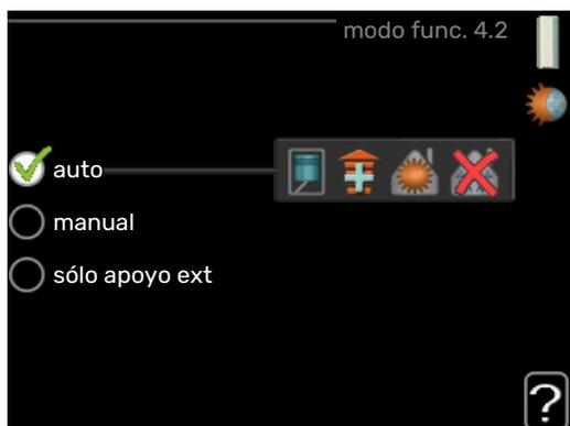
Normalmente, el modo de funcionamiento de la bomba de calor es "auto". También se puede seleccionar el modo "sólo apoyo ext", pero únicamente si se usa un suplemento, o el modo "manual" si prefiere seleccionar usted mismo las funciones de la bomba de calor.
