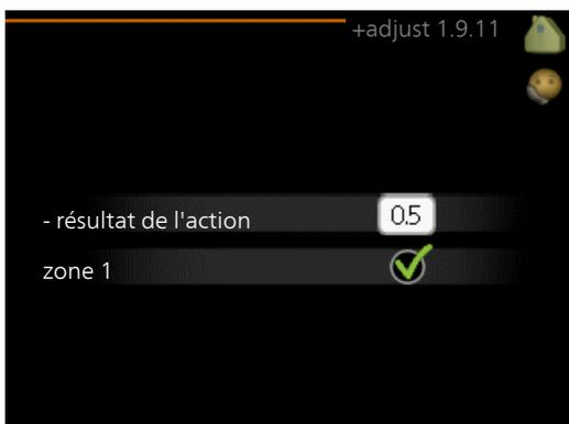
Avec la fonction +Adjust, l'installation communique avec le centre de commande\* du système de chauffage au sol et règle la courbe de chauffage ainsi que la température de départ en fonction du système de chauffage au sol.
