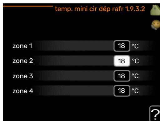
Dans le menu 1.9.3, vous sélectionnez chauffage ou rafraîchissement, dans le menu suivant (température de départ min. de chauffage/rafraîchissement) réglez la température minimum de la température de départ du système d'émission. Cela signifie que F1253 ne calculera jamais une température inférieure à celle définie ici.
