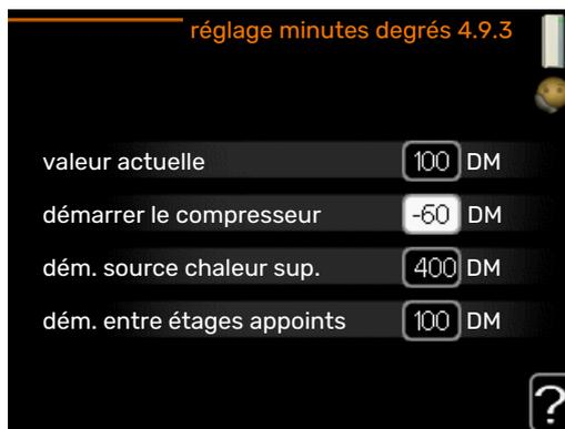
Les degrés minutes correspondent à une mesure du besoin actuel de chauffage dans l'habitation, et déterminent le moment où le compresseur démarre/s'arrête.
