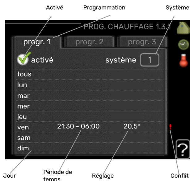
Vous pouvez programmer ici jusqu'à trois consignes de température et trois périodes par jour. Si la sonde d'ambiance est installée et activée, on règle les différentes températures en °C, si aucune sonde d'ambiance n'est activée, on règle plusieurs loi d'eau (menu 1.1). Augmenter d'un seul incréme-
