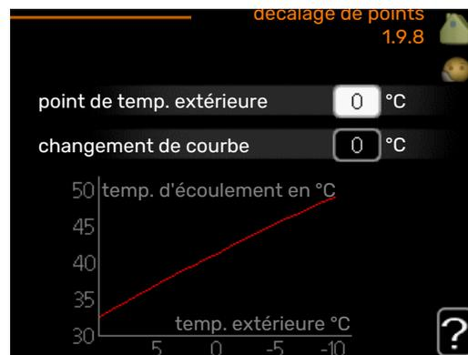
Sélectionnez ici un changement dans la loi d'eau à une certaine température extérieure. Augmenter d'un seul incrément suffit en général à modifier la température ambiante d'un degré mais dans certains cas plusieurs incréments sont nécessaires.
