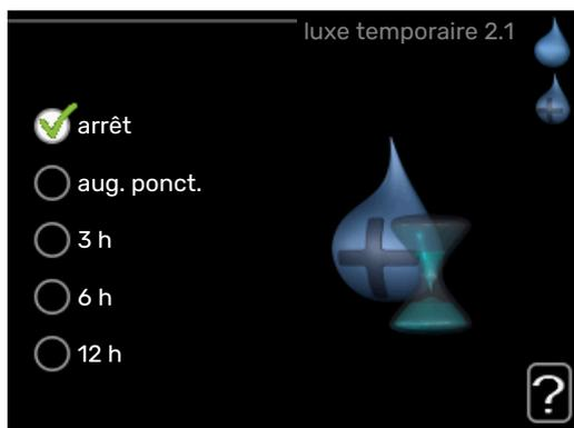
Lorsque les besoins en eau chaude augmentent temporairement, ce menu peut être utilisé pour choisir une augmentation de la température de l'eau chaude en mode Luxe pendant une durée sélectionnable.
