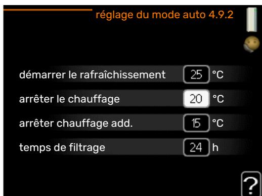
Lorsque le mode de fonctionnement est réglé sur « auto », la pompe à chaleur sélectionne le moment auquel le démarrage et l'arrêt de l'appoint et de la production de chaleur sont autorisés en fonction de la température extérieure moyenne. S'il existe des accessoires de rafraîchissement ou si la pompe à chaleur dispose d'une fonction de rafraîchissement intégrée, vous pouvez aussi sélectionner la température de démarrage du rafraîchissement.
