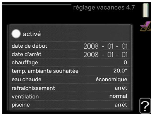
Pour réduire la consommation d'énergie pendant les vacances, vous pouvez programmer la baisse de la température du chauffage et de l'eau chaude. Le rafraîchissement, la ventilation et la piscine peuvent également être programmés si ces fonctions sont branchées.
