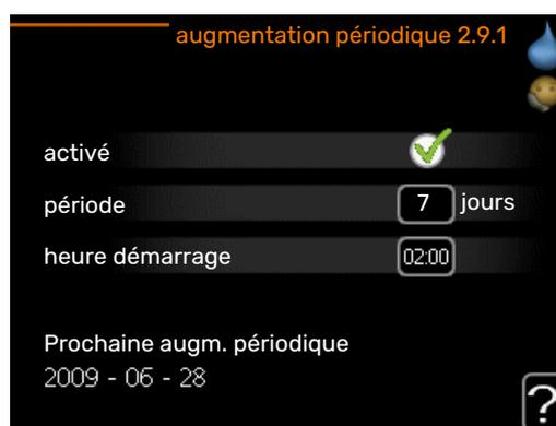
Pour éviter l'apparition de bactéries dans le préparateur ECS, le compresseur et l'appoint électrique immergé peuvent augmenter la température de l'eau chaude pendant un court moment à intervalles réguliers.
