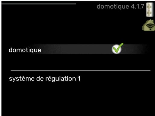
Lorsque vous disposez d'un système domotique capable de communiquer avec myUplink, l'activation de la fonction domotique dans ce menu vous permet de contrôler la F1253 par le biais d'une application.
