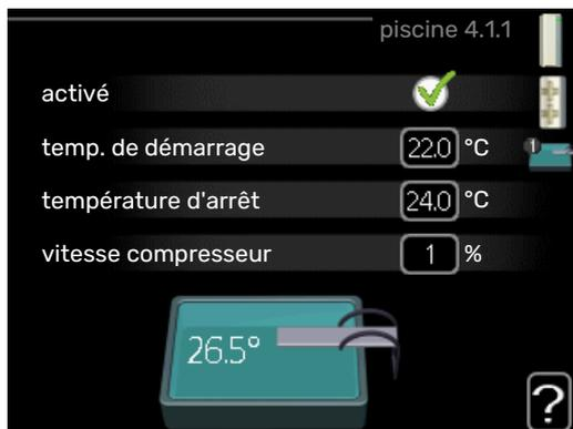
Sélectionnez si la commande de la piscine doit être activée et dans quelle plage de températures (température de démarrage et d'arrêt) la piscine doit être chauffée.
