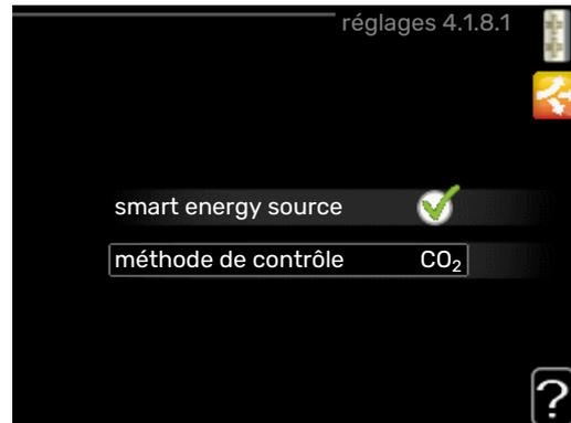
La fonction privilégie le mode/le degré d'utilisation de chaque source d'énergie raccordée. Vous pouvez indiquer si le système doit utiliser la source d'énergie la plus économique. Vous pouvez également indiquer si le système doit utiliser la source d'énergie la plus neutre.
