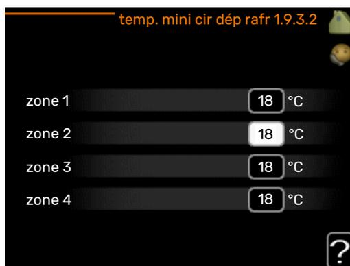
Dans le menu 1.9.3, vous sélectionnez chauffage ou rafraîchissement, dans le menu suivant (température de départ min. de chauffage/rafraîchissement) réglez la température minimum de la température de départ du système d'émission. Cela signifie que F1153 ne calculera jamais une température inférieure à celle définie ici.
