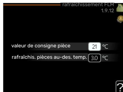
Après avoir activé rafraîchissement FLM dans le menu 5.3.1, vous pouvez régler la température ambiante souhaitée dans ce menu. Sélectionnez également la température à laquelle le rafraîchissement doit démarrer.
