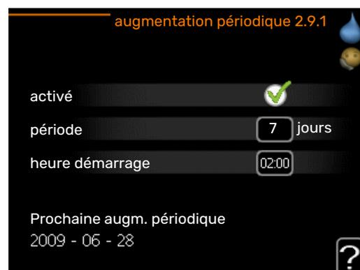
Pour éviter l'apparition de bactéries dans le préparateur ECS, le compresseur et l'appoint électrique immergé peuvent augmenter la température de l'eau chaude pendant un court moment à intervalles réguliers.
