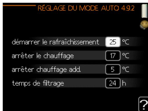
Si la température moyenne calculée par le « temps de filtrage » est supérieure à la température réglée, le rafraîchissement démarre alors conformément aux réglages définis dans le menu 1.9 (les réglages sont disponibles dans les menus 1.9.1.2, 1.9.3.2 et 1.9.5).
