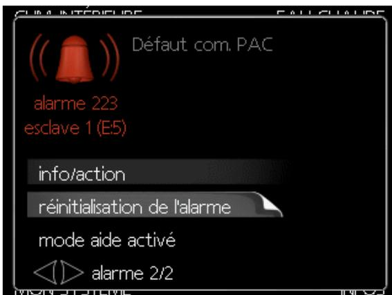
Une alarme rouge signifie la présence d'un dysfonctionnement que ni la pompe à chaleur ni le module de commande ne sont capables de régler. En faisant tourner la molette de réglage et en appuyant sur le bouton OK, il est possible d'afficher le type d'alarme et le supprimer. L'installation peut être également réglée en mode « aide ».
