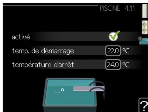
Sélectionnez si la commande de la piscine doit être activée, la plage de températures (de démarrage et d'arrêt) dans laquelle le chauffage de la piscine doit avoir lieu et le nombre de compresseurs pouvant fonctionner simultanément.
