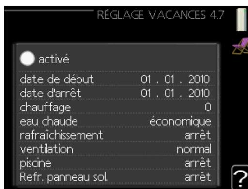
Pour réduire la consommation d'énergie pendant les vacances, vous pouvez programmer la baisse de la température du chauffage et de l'eau chaude sanitaire. Le rafraîchissement, la ventilation, le rafraîchissement de la piscine et par panneau solaire peuvent également être programmés si ces fonctions sont branchées.
