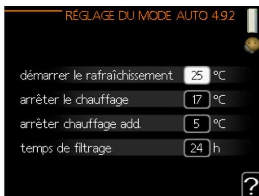
Lorsque le mode de fonctionnement est réglé sur « auto », le module commande définit quand le démarrage et l'arrêt de l'appoint et de la production de chaleur sont permis, selon la température extérieure moyenne. Si la pompe à chaleur est équipée d'une fonction de rafraîchissement intégrée et qu'elle est activée dans le menu, vous pouvez également sélectionner la température de démarrage du rafraîchissement.
