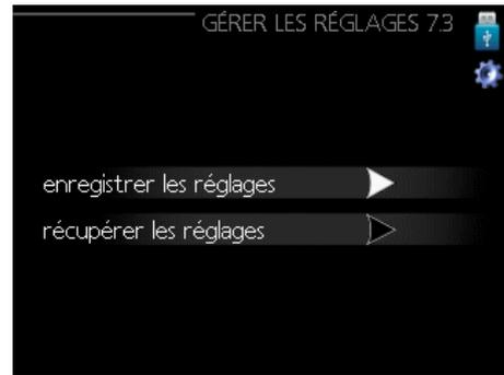
Ce menu permet de gérer (enregistrer ou restaurer) tous les réglages de l'utilisateur (menu utilisateur et menu entretien) dans le dispositif de commande à partir de la clé USB. La fonction « enregistrer réglages » permet de sauvegarder les réglages des menus sur la clé USB afin de les restaurer par la suite ou de les importer sur un autre régulateur.
