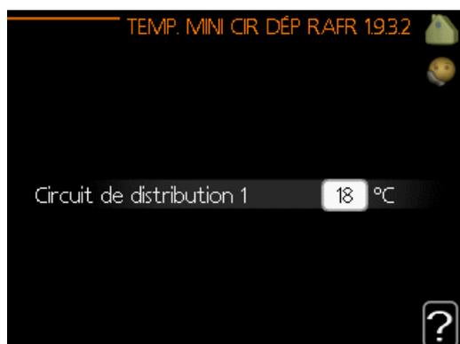
Dans le menu 1.9.3, vous sélectionnez chauffage ou rafraîchissement, dans le menu suivant (température de départ min. de chauffage/rafraîchissement) réglez la température minimum de la température de départ du système d'émission.
