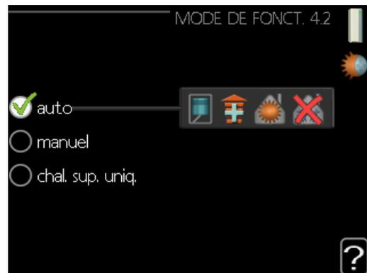
Le mode de fonctionnement du module de commande est généralement réglé sur « auto ». Il est également possible de régler le module de commande sur « chal. sup. uniq. » quand seul un appoint est utilisé, ou « manuel » puis sélectionnez les fonctions autorisées.
