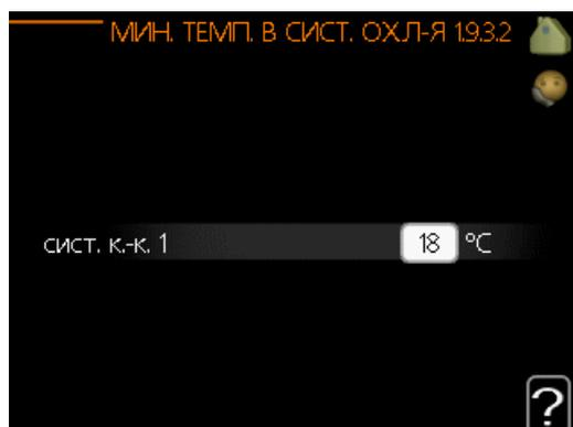
В меню 1.9.3 можно выбрать нагрев или охлаждение, в следующем меню (мин. температура подачи при нагреве/охлаждении) установите минимальную температуру подаваемого теплоносителя для системы климат-контроля.
