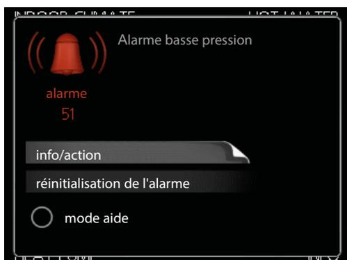
Si une alarme se déclenche accompagnée d'un voyant d'état rouge, cela indique un dysfonctionnement que ni la pompe à chaleur ni le module de commande ne sont capables de régler. En tournant le bouton de commande et en appuyant sur OK, vous pouvez afficher à l'écran le type d'alarme et procéder à sa réinitialisation. Vous pouvez également choisir de régler l'installation sur mode « aide ».
