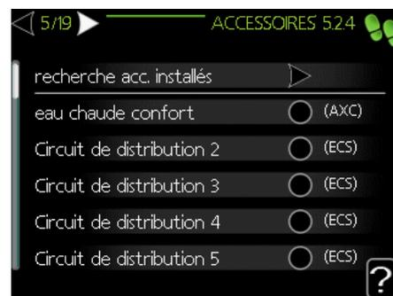
Si un ou plusieurs accessoires sont sélectionnés, le menu 5.3 « Réglages accessoires » affiche les réglages possibles pour chaque accessoire sélectionné. Accédez le menu 5.3. lorsqu'un accessoire est sélectionné.
