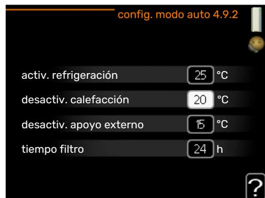
Cuando el modo de funcionamiento está en "auto", la bomba de calor decide cuándo activar y desactivar el apoyo externo y la producción de calefacción, dependiendo de la temperatura exterior media. Si están instalados los accesorios para refrigeración o la bomba de calor tiene integrada la función de refrigeración, también puede seleccionar la temperatura de activación de la refrigeración.
