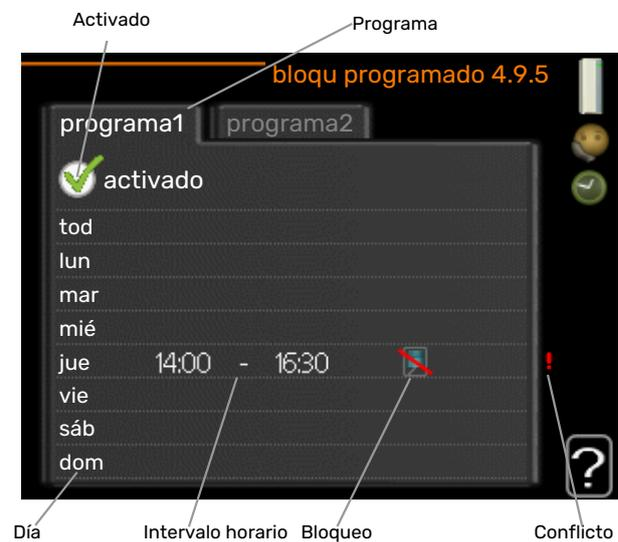
Aquí puede programar hasta dos periodos horarios distintos en los que desee que los compresores de la bomba de calor y/o el apoyo externo permanezcan bloqueados. Si hay varias bombas de calor conectadas como principal/secundarias, sus compresores también se bloquean.
