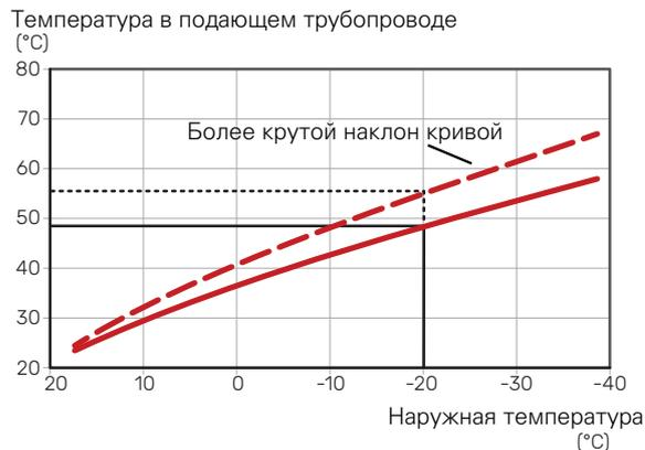
Оптимальный наклон кривой зависит от климатических условий и самого низкого значения температуры наружного воздуха в той или иной местности, наличия в доме радиаторов, вентиляторных доводчиков (фанкойлов) или подогрева пола и качества теплоизоляции дома.
