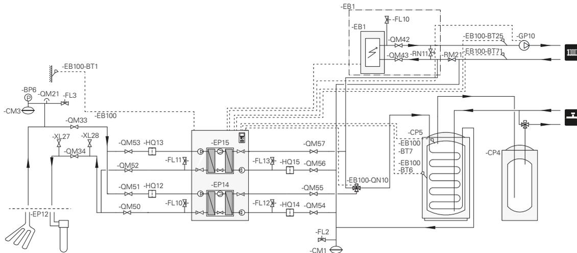
Тепловой насос (EB100) устанавливает приоритет подачи горячей воды с модулем охлаждения (EP14) через реверсивный клапан (EB100-QN10). Когда водонагреватель / накопительный бак (CP5) полностью залит, (EB100-QN10) переключается на нагревательный контур системы отопления. Когда существует потребность в отоплении, компрессорный модуль (EP15) запускается в первую очередь. При большей потребности для отопления также запускается модуль охлаждения (EP14).
