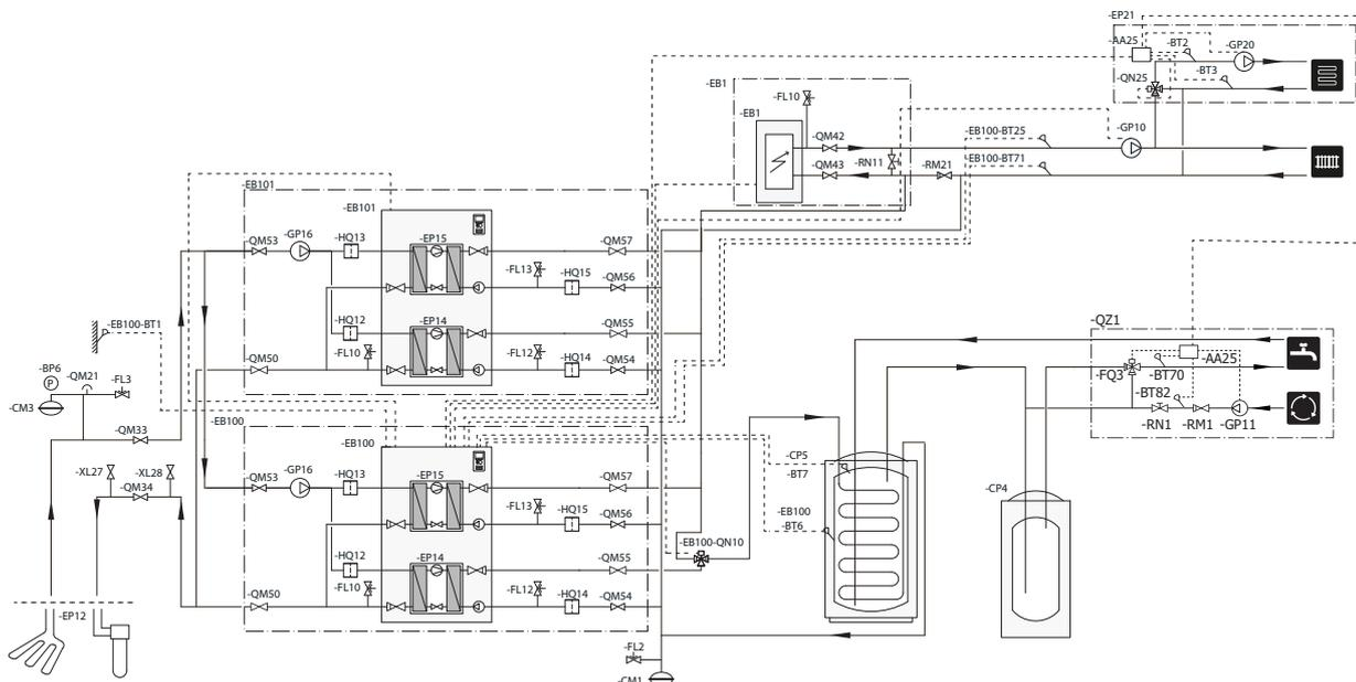
Тепловой насос (EB100) устанавливает приоритет подачи горячей воды с модулем охлаждения (EP14) через реверсивный клапан (EB100-QN10). Когда водонагреватель / накопительный бак (CP5) полностью залит, (EB100-QN10) переключается на нагревательный контур системы отопления. При необходимости нагрева вначале запускается модуль охлаждения (EP15) в тепловом насосе (EB101). При большом расходе также запускается компрессорный модуль (EP14) в (EB101) для отопления.
