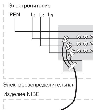
3. Подсоедините кабель к клеммной колодке AA101-X10:15 к AA101-X10:16 и AA101-X10:17, а также к общей клеммной колодке AA101-X10:18 для трех датчиков тока.
