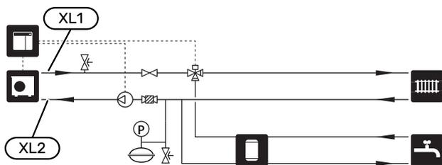
L'image présente un raccordement au module de commande.
