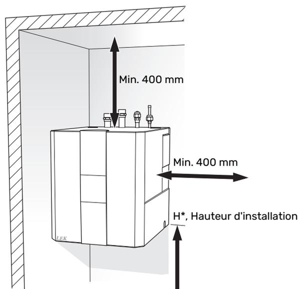
\* Si la quantité totale de fluide frigorigène est supérieure à 1,84 kg R32, la hauteur d'installation et le sol de la zone d'installation sont soumis à des exigences spécifiques, voir la section « Exigences relatives à l'espace d'installation ».
