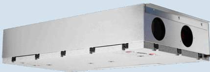
NIBE ERS 20-300 ist ein kompaktes Lüftungsgerät für die platzsparende Deckenmontage. Es ist mit einem leistungsfähigen Kreuzgegenstrom-Wärmetauscher, einem Sommerbypass, Filtern sowie Ventilatoren für Zu- und Abluft ausgestattet.
