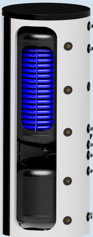
Dieser Wärmepumpen-Kombispeicher ist als platzsparende Lösung für den Einsatz im Einfamilienhaus konzipiert. Er besteht aus zwei Behältern, wobei der Brauchwasserspeicher über ein Volumen von 222 Liter, der Pufferspeicher über ein Volumen von 125 Liter verfügt. Beide Teilspeicher sind thermisch voneinander getrennt, so dass es zu keiner gegenseitigen Beeinträchtigung der einzelnen Speicherbereiche kommen kann.
