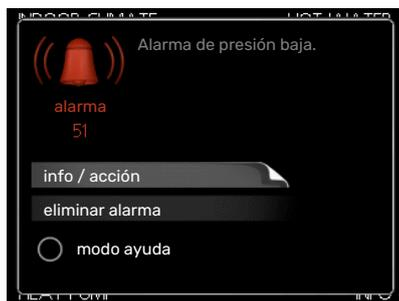
Cuando se produce una alarma, es porque se ha producido algún tipo de problema de funcionamiento; el piloto de estado cambia de verde fijo a rojo fijo. Además, en la ventana de información aparece una campana de alarma.
