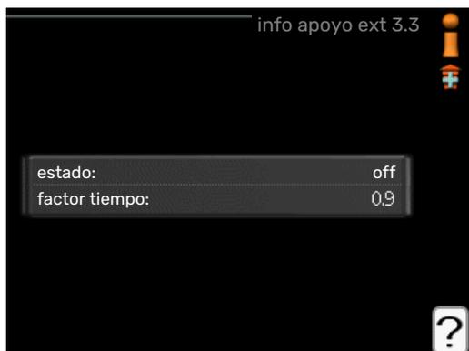
Muestra información sobre la configuración del apoyo externo, su estado de funcionamiento y estadísticas. No permite efectuar cambios.
