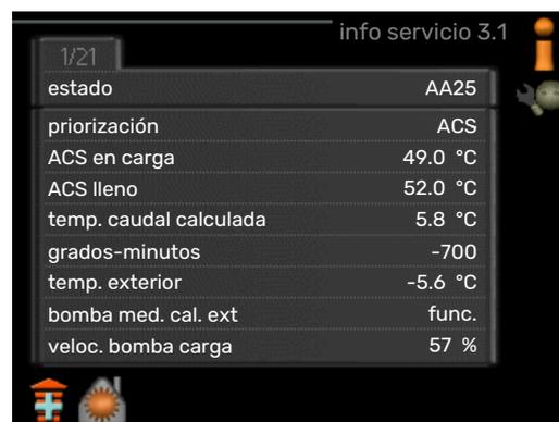
Muestra información sobre el estado de funcionamiento real de la instalación (temperaturas actuales, etc.). No permite efectuar cambios.
