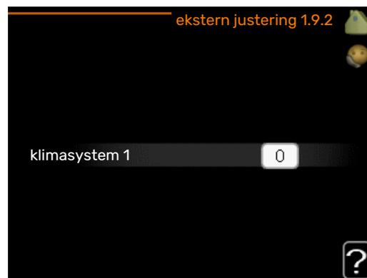
Ved å koble til en utvendig kontakt, for eksempel romtermostat eller et koblingsur, kan romtemperaturen settes opp eller ned under oppvarmingen, enten midlertidig eller periodevis. Når kontakten er på, endres forskyvningen av varmekurven med det antall trinn som er valgt i menyen. Hvis romføler er installert og aktivert, stilles ønsket romtemperatur (°C) inn.
