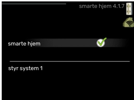
Når du har et smarte hjem-system som kan snakke med myUplink, kan du ved å aktivere smarte hjem-funksjonen styre SMO 20 via en app.
