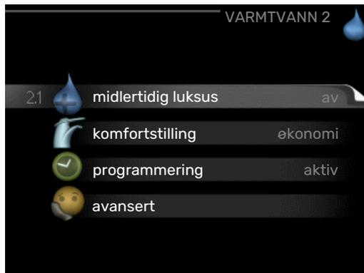
Denne menyen vises bare hvis varmtvannsbereideren er installert mot varmepumpen.
