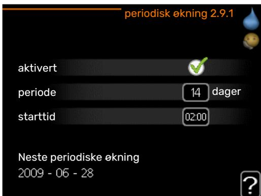
For å hindre bakterievekst i varmtvannsberederen kan varmpumpen sammen med eventuell tilleggsvarme med jevne mellomrom øke varmtvannstemperaturen på kort tid.
