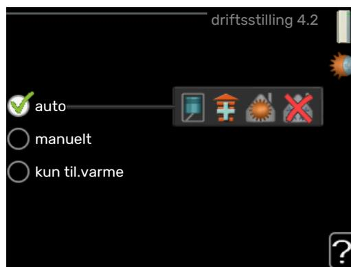
Styremodulens driftsstilling er normalt innstilt i "auto". Du har også mulighet til å sette styremodulen på "kun til.varme" når bare tillegg benyttes, eller "manuelt" og selv velge hvilke funksjoner som skal tillates.
