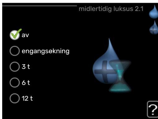
Ved midlertidig økt varmtvannsbehov kan du fra denne menyen velge å øke varmtvannstemperaturen til en luksustillingen under valgbar tid.
