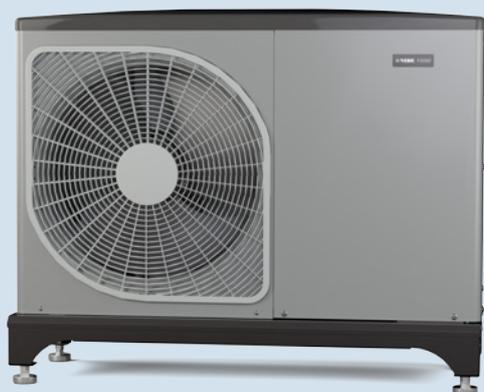
La gamme de pompes à chaleur monoblocs NIBE F2050 est issue d'un cahier des charges NIBE très exigeant pour proposer des solutions performantes et durables. Elle propose des températures de départ jusqu'à 58°C par -20°C extérieure et s'adapte aux besoins grâce à son compresseur inverter et son système de régulation intelligent. Elle intègre un fluide frigorigère respectueux du climat pour réduire son impact sur l'environnement.
