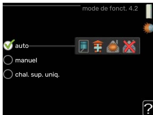
Le mode de fonctionnement du module intérieur est généralement réglé sur « auto ». Il peut aussi être réglé sur « chal. sup. uniq. », mais uniquement lorsqu'un appoint est utilisé. En revanche, si vous préférez sélectionner vous-même les fonctions autorisées, réglez-le sur « manuel ».
