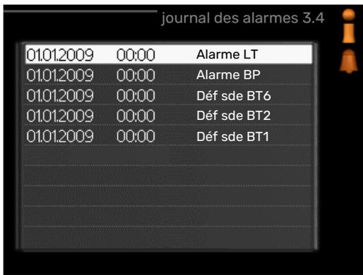
Pour faciliter la détection des dysfonctionnements, l'état de fonctionnement de l'installation lors des alertes d'alarme est enregistré ici. Vous pouvez consulter les informations des 10 dernières alarmes déclenchées.
