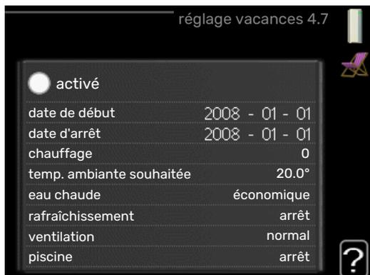
Pour réduire la consommation d'énergie pendant les vacances, vous pouvez programmer la baisse de la température du chauffage et de l'eau chaude sanitaire. Le rafraîchissement, la ventilation, le rafraîchissement de la piscine et par panneau solaire peuvent également être programmés si ces fonctions sont branchées.
