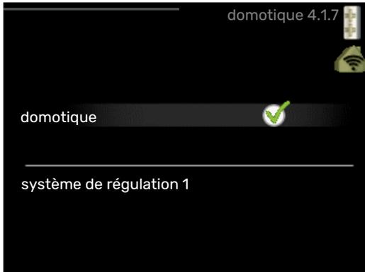
Lorsque vous disposez d'un système domotique capable de communiquer avec NIBE Uplink, l'activation de la fonction domotique dans ce menu vous permet de contrôler la VVM 500 par le biais d'une application.
