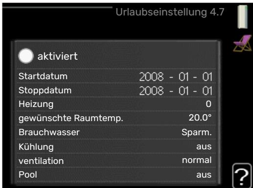
Um den Energieverbrauch während des Urlaubs zu reduzieren, können Sie eine Absenkung von Heizungs- und Brauchwassertemperatur zeitlich steuern. Kühlung, Ventilation, Pool und Solarkollektorkühlung lassen sich ebenfalls über ein Zeitprogramm steuern, sofern die Funktionen eingeschlossen sind.
