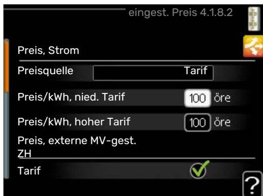
Hier legen Sie fest, ob für das System eine Spot-, Tarif- oder Festpreissteuerung gelten soll. Die Einstellung wird für jede einzelne Energiequelle vorgenommen. Spotpreise sind nur bei einem Stromvertrag auf Stundenpreisbasis verfügbar.
