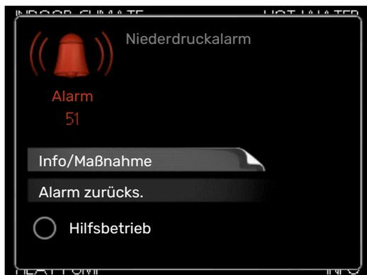
Bei einem Alarm ist eine Betriebsstörung aufgetreten. Die Statuslampe leuchtet dabei nicht mehr durchgehend grün, sondern durchgehend rot. Außerdem erscheint im Informationsfenster ein Alarmglockensymbol.
