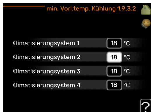
In Menü 1.9.3 wählen Sie Heizung oder Kühlung aus. Im nächsten Menü (min. Vorl.temp. Heizung/Kühlung) stellen Sie die minimale Vorlauftemperatur zum Klimatisierungssystem ein. Dementsprechend berechnet VVM 500 niemals eine Temperatur, die unter dem hier eingestellten Wert liegt.
