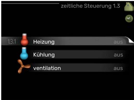
In Menü **zeitliche Steuerung** wird die zeitliche Steuerung des Innenklimas (Heizung/Kühlung/ventilation) für jeden Wochentag festgelegt.
