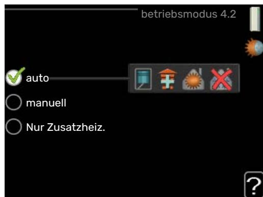
Die Betriebsstufe des Innenmoduls wird normalerweise hier eingestellt: "auto". Außerdem können Sie das Innenmodul in folgenden Zustand versetzen: "Nur Zusatzheiz.", wenn ausschließlich die Zusatzheizung verwendet werden soll oder "manuell" selbst festgelegt wird, welche Funktionen zulässig sein sollen.
