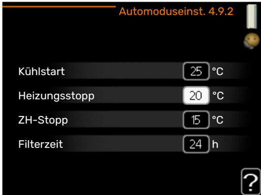
Wenn als Betriebsmodus "auto" eingestellt ist, bestimmt das Innenmodul ausgehend von der mittleren Außenlufttemperatur selbst, wann Start und Stopp der Zusatzheizung sowie der Brauchwasserbereitung zulässig sind. Wenn Kühlzubehör vorhanden ist oder die Wärmepumpe über eine integrierte Kühlfunktion verfügt und diese im Menü aktiviert ist, können Sie hier die Starttemperatur für die Kühlung festlegen.
