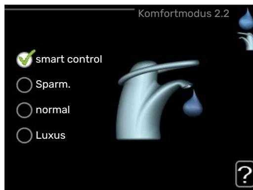
Der Unterschied zwischen den verfügbaren Modi besteht in der Brauchwassertemperatur. Bei einer höheren Temperatur steht mehr Brauchwasser zur Verfügung.
