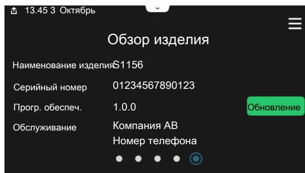
Здесь можно найти информацию о названии и серийном номере изделия, версии программного обеспечения и назначении. Когда новое программное обеспечение доступно для загрузки, вы можете загрузить его здесь (при условии подключения S1156 к myUplink).
