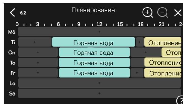
Если установлен и активирован комнатный датчик, требуемая комнатная температура (°C) устанавливается в течение периода времени.
