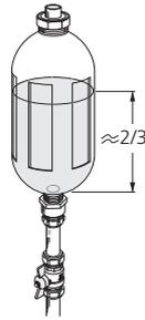
При необходимости увеличить давление в системе следует закрыть клапан на главном отводящем трубопроводе, когда рассольный насос (GP2) работает и уравнительный сосуд (СМ2) открыт, чтобы жидкость отводилась из сосуда.
