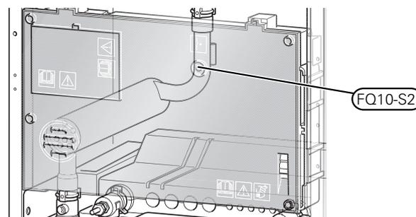
Ограничитель температуры (FQ10) отключает электропитание дополнительного электрического источника тепла, если температура поднимается выше 89 °C и обнуляется вручную.
