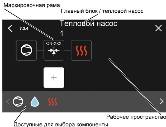
*Главный блок / тепловой насос:* здесь выбирается тепловой насос, для которого должны быть выполнены настройки стыковки (если это единственный тепловой насос в системе, отображается только главный блок).
