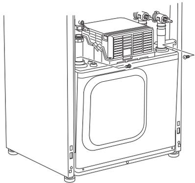
6. Отсоедините разъёмы (XF2), ((XF11)) и ((XF22)).
