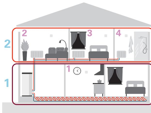
На этом примере показан дом с двумя системами климат-контроля (1 и 2, два отдельных этажа), разделенными на четыре зоны (1-4, четыре разных помещения). Температуру и вентиляцию по потребности можно регулировать индивидуально для каждой зоны (требуется дополнительное устройство).
