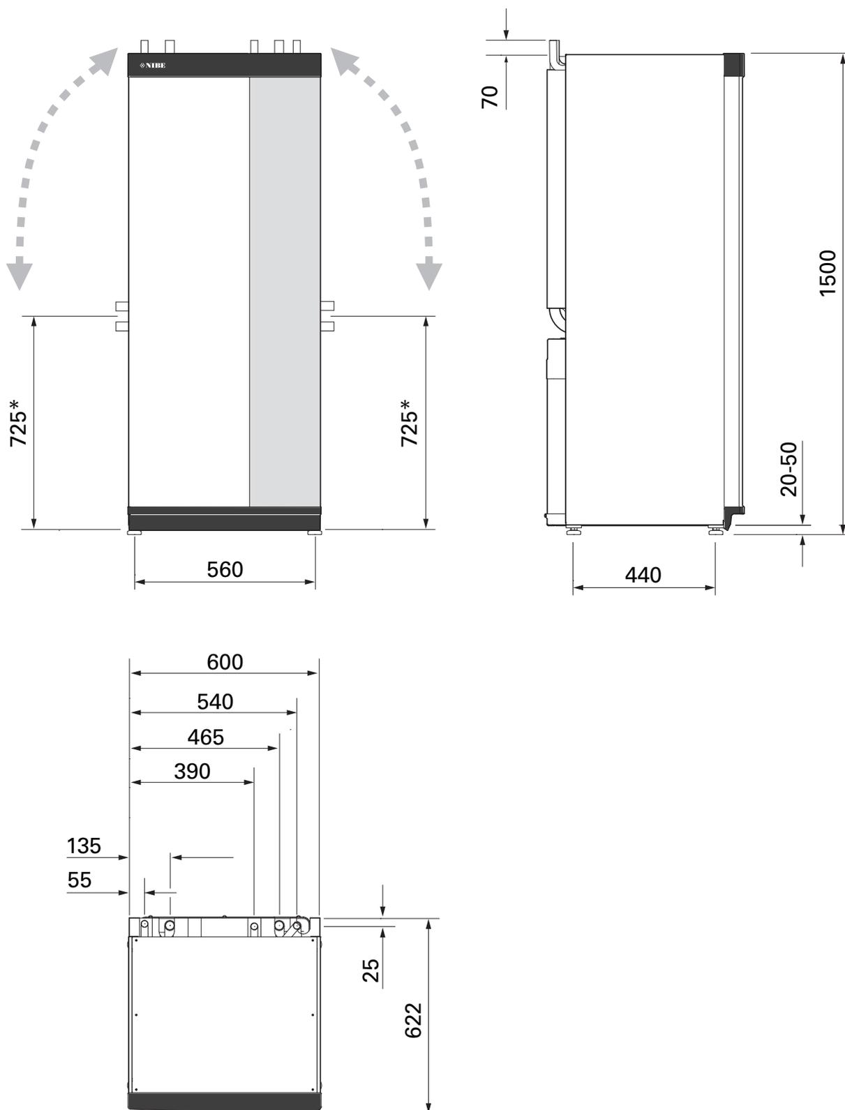
\* Данный размер применяется с учетом угла 90° на трубах подачи рассола (боковое соединение). Отклонение размера может составлять прикл. ±100 мм по вертикали, поскольку трубы для подачи рассола частично являются гибкими.
