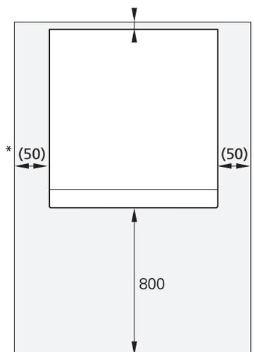
\* Требуемое расстояние при обычной установке составляет 300 - 400 мм (со всех сторон) для подключения оборудования, например уравнильного сосуда, клапанов и электрооборудования.
