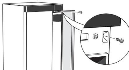
2. Потяните верхний край панели на себя и поднимите ее по диагонали вверх, чтобы извлечь ее из рамы.
