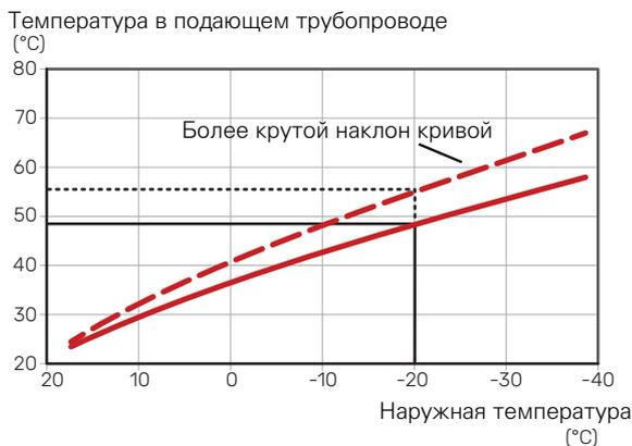
Оптимальный наклон кривой зависит от климатических условий в той или иной местности, наличия в доме радиаторов, вентиляторных доводчиков (фанкойлов) или подогрева пола и качества теплоизоляции дома.
