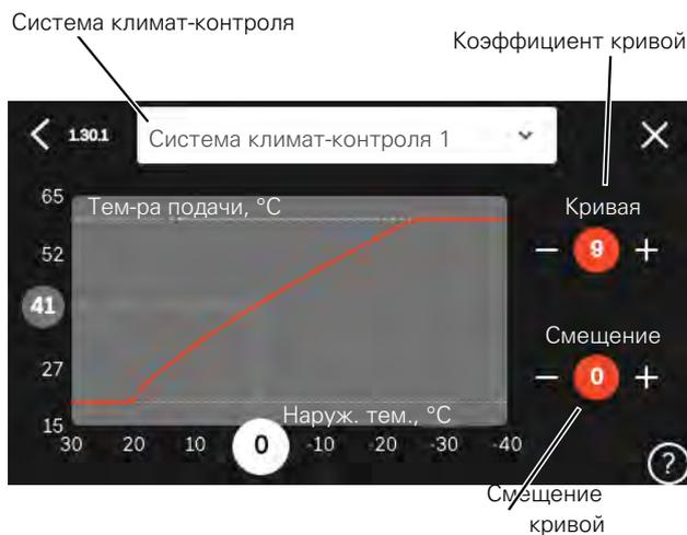
1. Выберите систему климат-контроля (при наличии двух и более), для которой следует изменить кривую нагрева.
