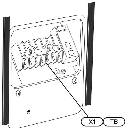
Le bus de communication est raccordé au bornier X1(TB).
