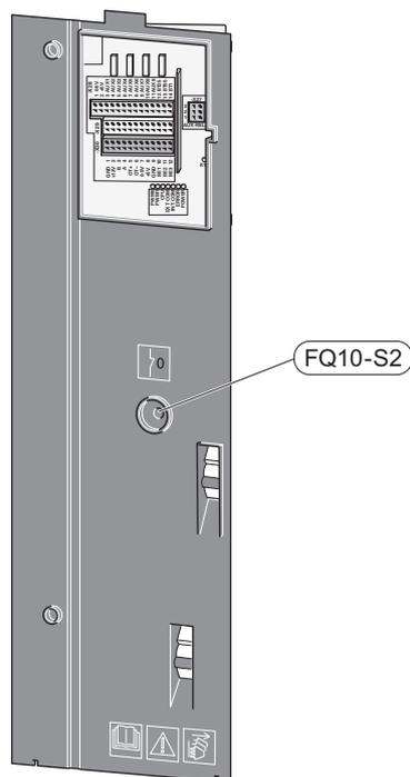
Le limiteur de température (FQ10) coupe l'alimentation électrique de l'appoint électrique supplémentaire si la température dépasse 89 °C. Il doit être réinitialisé manuellement.
