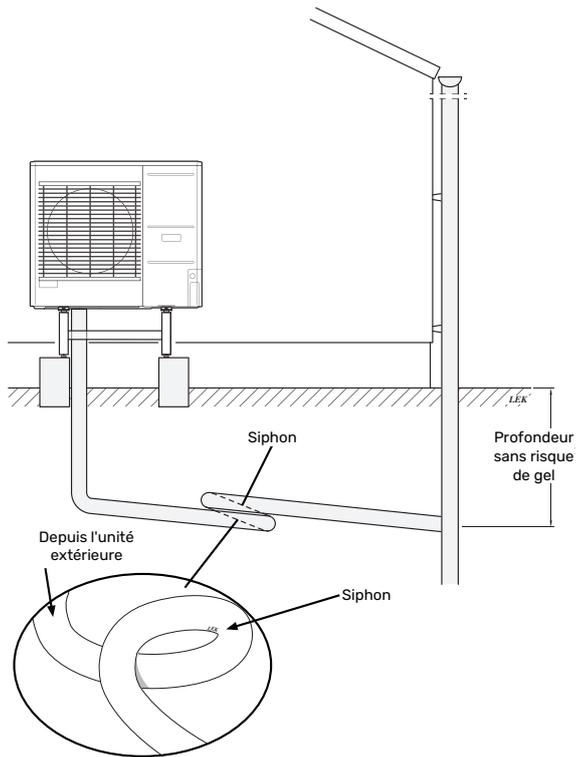
La longueur d'installation peut être adaptée à la taille du joint hydraulique.
