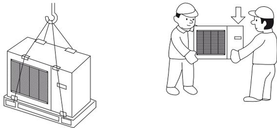
Si l'unité extérieure doit être transportée sur un sol meuble, tel que de la pelouse, il est recommandé de la lever à l'aide d'une grue jusqu'à l'emplacement d'installation. Lors du levage de l'unité extérieure à l'aide d'une grue, l'emballage doit rester intact.
