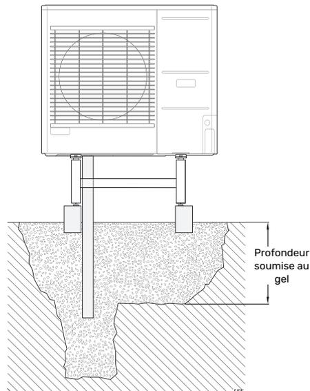
Si l'habitation dispose d'une cave, le puits perdu doit être positionné de sorte que les condensats n'affectent pas l'habitation. Sinon, il peut être placé directement sous l'unité extérieure.
