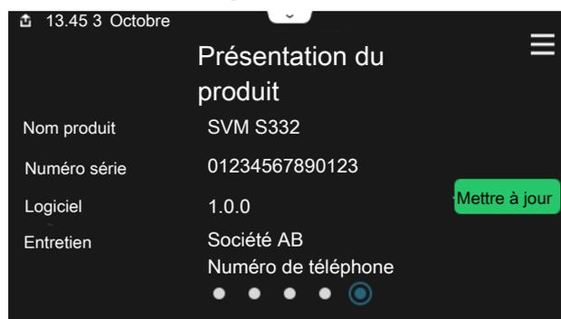
Vous pouvez rechercher ici des informations sur le nom du produit, le numéro de série du produit, la version du logiciel et l'entretien. Les nouvelles versions du logiciel peuvent être téléchargées ici (si SVM S332 est connecté à myUplink).
