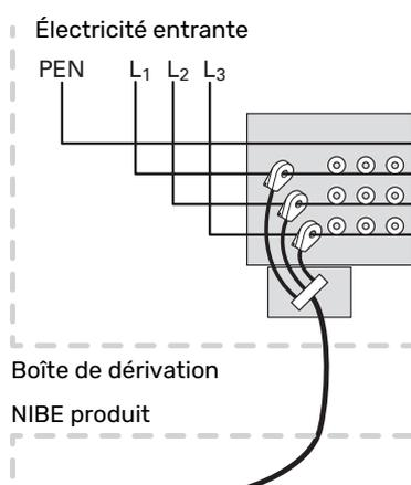
3. Raccordez le câble au bornier AA2-X30:9-12, où X30:9 est le bornier commun pour les trois capteurs d'intensité.
