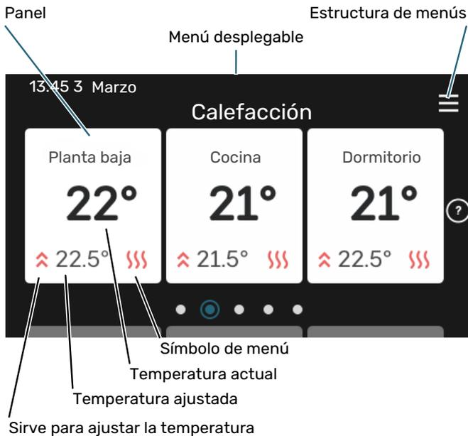
Pulse la tarjeta para ajustar el valor deseado. En determinadas páginas de función tendrá que arrastrar hacia arriba o hacia abajo con el dedo para ver más paneles.
