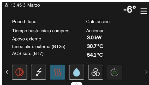
Pulse los iconos del borde inferior del menú para obtener más información sobre cada función. Utilice la barra de desplazamiento para ver toda la información de la función seleccionada.
