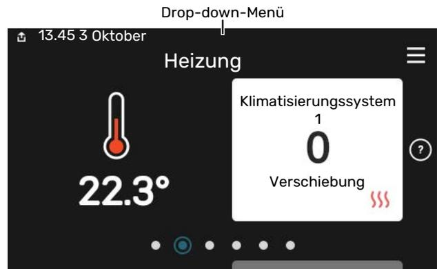
Das Drop-down-Menü zeigt den aktuellen Status von SVM S332, welche Teile in Betrieb sind und was SVM S332 derzeit ausführt. Die derzeit in Betrieb befindlichen Funktionen werden mittels eines Rahmens markiert
