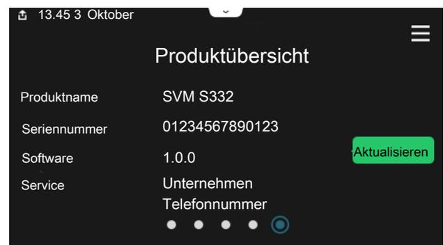
Hier finden Sie Angaben wie die Produktbezeichnung, die Seriennummer des Produkts, die Version der Software und den Service. Eventuelle Software kann hier heruntergeladen werden (sofern SVM S332 mit myUplink verbunden ist).
