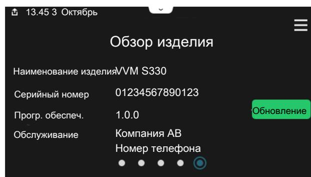
Здесь можно найти информацию о названии и серийном номере изделия, версии программного обеспечения и назначении. Когда новое программное обеспечение доступно для загрузки, вы можете загрузить его здесь (при условии подключения VVM S330 к myUplink).
