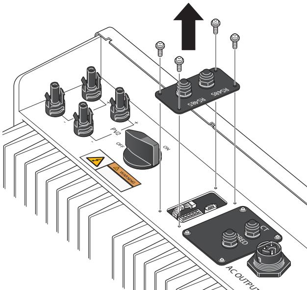
3. Das weiße Kabel vorsichtig hervornehmen und am Kommunikationsmodul anschließen (unter Umständen befindet sich das Kabel versteckt unter der Kante). Das Kabel ist an einem Ende angeschlossen; daher vorsichtig hervorziehen und an CMO 11 anschließen.
