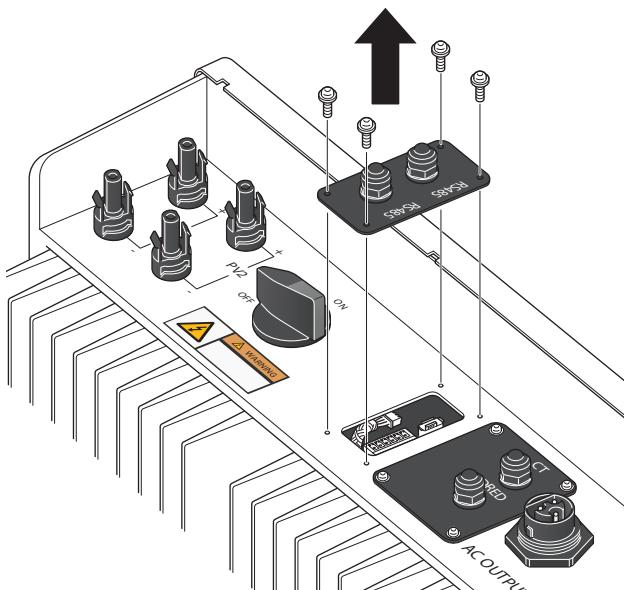
3. Ta ut den vita kabeln och montera den i kommunikationsmodulen. Den kan ligga dolt under kanten, pilla försiktigt fram den. Den är ansluten i ena änden så dra ut den försiktigt och ansluta den till CMO 11.
