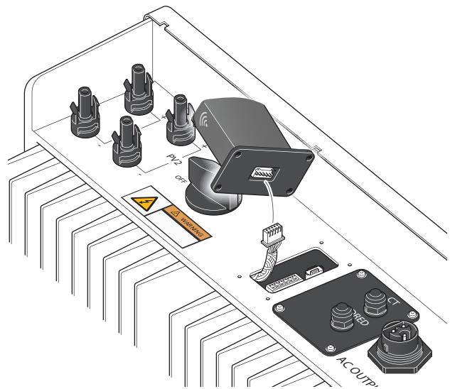
4. Skruva fast kommunikationsmodulen, kontrollera att kabeln sitter ordentligt innan du skruvar fast den.
