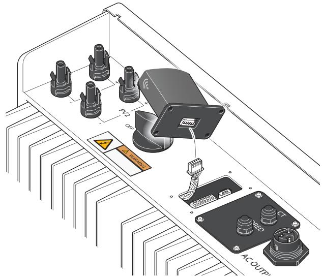
4. Das Kommunikationsmodul festschrauben und kontrollieren, ob das Kabel korrekt angeschlossen ist, bevor es festgeschraubt wird.
