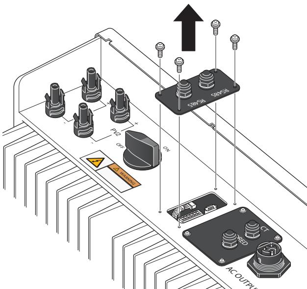
3. Ota ulos valkoinen kaapeli ja kytke se tiedonsiirtomoduuliin. Se voi olla pillossa reunan alla, kampea se varovasti esiin. Sen toinen pää on kytketty, joten vedä se varovasti ulos ja kytke CMO 11-moduuliin.
