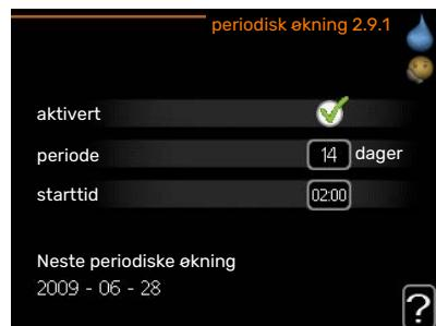
For å hindre bakterievekst i varmtvannsberederen kan varmepumpen sammen med eventuell tilleggsvarme med jevne mellomrom øke varmtvannstemperaturen på kort tid.
