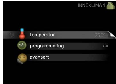
**programmering** Programmering av varme og kjøling. Statusinformasjonen "innstilt" betyr at du har stilt inn programmering, men at den ikke er aktiv akkurat nå, "ferieinnstilling" vises hvis ferieprogrammering er aktiv samtidig med programmering (i og med at feriefunksjonen er prioritert), "aktiv" vises hvis deler av programmeringen er aktiv, ellers vises "av".
