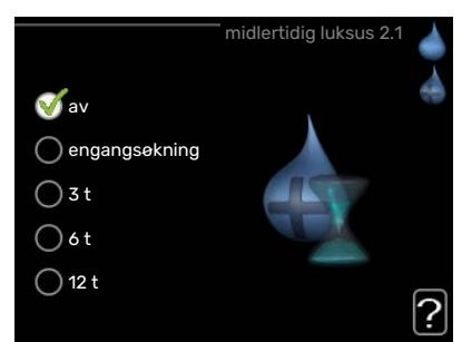
Ved midlertidig økt varmtvannsbehov kan du fra denne menyen velge å øke varmtvannstemperaturen til en luksusstillingen under valgbart tid.
