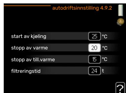
Når driftsstillingen er satt til "auto", velger styremodulen selv, avhengig av gjennomsnittlig innetemperatur, når start og stopp av tilleggsvarme samt varmeproduksjon skal tillates. Hvis varmepumpen har en innebygd funksjon for kjøling og er aktivert i menyen, kan du også velge starttemperatur for kjøling.
