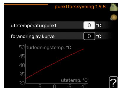
Her kan du velge en endring av varmekurven ved en viss utetemperatur. For én grads endring av romtemperaturen kreves vanligvis ett trinn, men i visse tilfeller kan flere trinn behøves.
