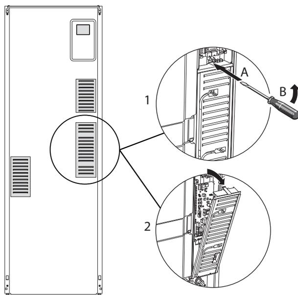
1. Inserte el destornillador (A) y empuje con cuidado el enganche hacia abajo (B).
