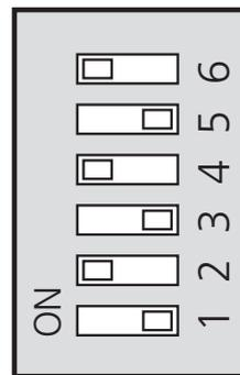
La figura muestra el interruptor DIP (AA1-SF1) con el ajuste de fábrica, es decir, 8 kW.
