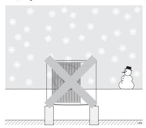
Не допускайте накопления снега, покрытия им решеток и дренажных отверстий на F2120.
