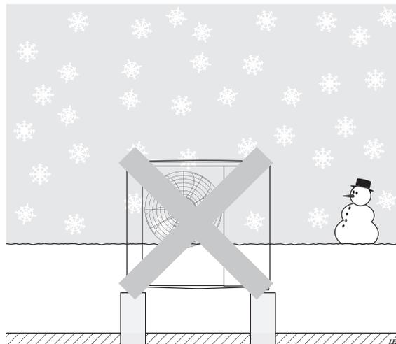
Не допускайте накопления снега, покрытия им решеток и дренажных отверстий на S2125.
