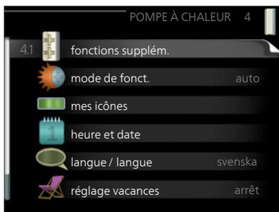
**mode de fonct.** Activation du mode de fonctionnement manuel ou automatique. L'information d'état indique le mode de fonctionnement sélectionné.
