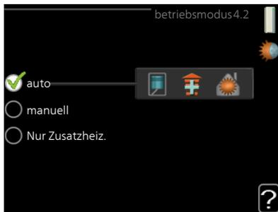
Der Betriebsmodus der Wärmepumpe wird normalerweise auf "auto" gestellt. Sie können die Wärmepumpe ebenfalls auf "Nur Zusatzheiz." stellen, wenn nur eine Zusatzheizung verwendet wird. Bei Auswahl von "manuell" können Sie die zugelassenen Funktionen selbst auswählen.
