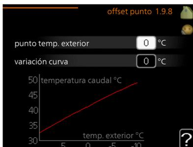
Permite definir un cambio en la curva de calor a determinada temperatura exterior.
