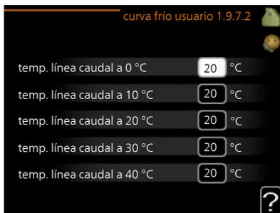
Cree aquí una curva de calor o de refrigeración propia, si tiene requisitos especiales, definiendo las temperaturas de caudal deseadas para distintas temperaturas exteriores.
