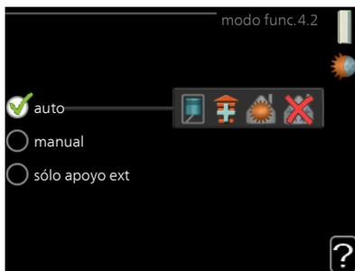
Normalmente, el modo de funcionamiento de la unidad interior es "auto". También se puede seleccionar el modo "sólo apoyo ext", pero únicamente si se usa un suplemento, o el modo "manual" si prefiere seleccionar usted mismo las funciones.
