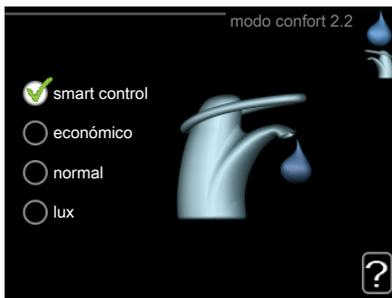
La diferencia entre los distintos modos es la temperatura del agua que sale del grifo de agua caliente. A mayor temperatura, más dura el agua caliente.
