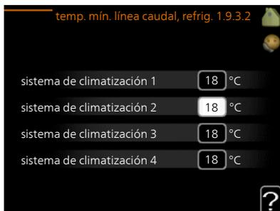
Seleccione calefacción o refrigeración en el menú 1.9.3 y, en el siguiente menú (temp. caudal mín. calefacción/refrigeración), defina la temperatura de caudal mínima del sistema climatizador. Esto significa que la unidad VVM 500 no calcula nunca temperaturas inferiores a la definida en este menú.
