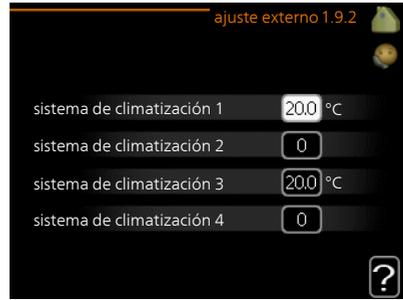
La instalación de un contacto externo, por ejemplo un termostato de habitación o un temporizador, permite aumentar o reducir la temperatura interior de forma temporal o periódica con la calefacción encendida. Cuando el contacto se activa, la desviación de la curva de calor se modifica en el número de pasos seleccionado en el menú. Si hay un sensor de habitación instalado y activado, se ajusta la temperatura interior deseada (°C).
