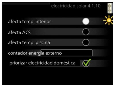
Aquí es donde se define la parte de la instalación (temperatura interior, temperatura del agua caliente, temperatura de la piscina) que se va a beneficiar del excedente de electricidad solar.
