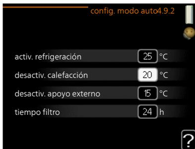
Cuando el modo de funcionamiento está en "auto", la unidad interior decide cuándo activar y desactivar el apoyo externo y la producción de calefacción, dependiendo de la temperatura exterior media. Si están instalados los accesorios para refrigeración o la bomba de calor tiene integrada la función de refrigeración y esta ha sido activada en el menú, también se puede seleccionar la temperatura de activación de la refrigeración.
