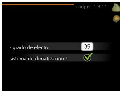
Con +Adjust, la instalación se comunica con el sistema de control de la calefacción por suelo radiante\* y ajusta la curva de calor y la temperatura de caudal calculada en función del sistema de calefacción por suelo radiante.
