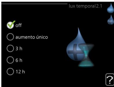
Si la necesidad de agua caliente aumenta temporalmente, se puede usar este menú para seleccionar un aumento de la temperatura del agua caliente configurando el modo lux durante un periodo de tiempo seleccionable.
