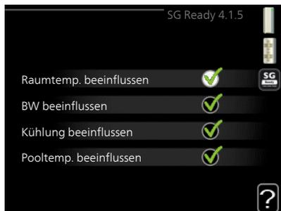
Im Niedrigpreismodus von „SG Ready“ wird die Parallelverschiebung der Innentemperatur um „+1“ erhöht. Ist ein Raumfühler installiert und aktiviert, wird stattdessen die gewünschte Raumtemperatur um 1 °C erhöht.
