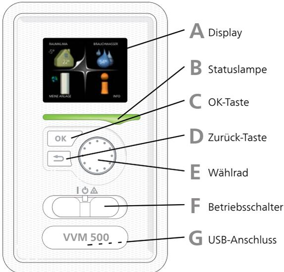
Hinter der Innenmodultür befindet sich ein Bedienfeld, das zur Kommunikation mit VVM 500 verwendet wird. Das sind Sie:
