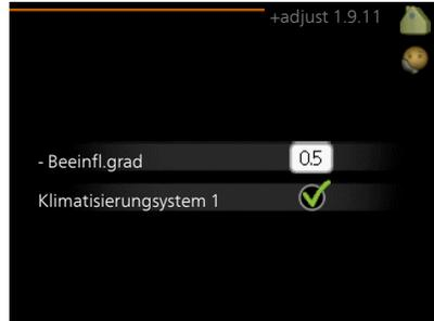
Mithilfe von +Adjust kommuniziert die Anlage mit der Steuereinheit für die Fußbodenheizung\* und passt die Heizkurve sowie die berechnete Vorlauftemperatur an die Fußbodenheizung an.
