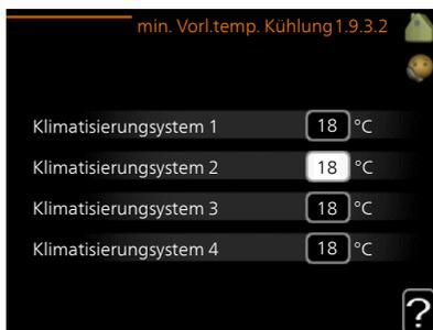
In Menü 1.9.3 wählen Sie Heizung oder Kühlung aus. Im nächsten Menü (min. Vorl.temp. Heizung/Kühlung) stellen Sie die minimale Vorlauftemperatur zum Klimatisierungssystem ein. Dementsprechend berechnet VVM 500 niemals eine Temperatur, die unter dem hier eingestellten Wert liegt.
