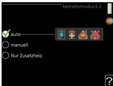
Die Betriebsstufe des Innenmoduls wird normalerweise hier eingestellt: "auto". Außerdem können Sie das Innenmodul in folgenden Zustand versetzen: "Nur Zusatzheiz.", wenn ausschließlich die Zusatzheizung verwendet werden soll oder "manuell" selbst festgelegt wird, welche Funktionen zulässig sein sollen.
