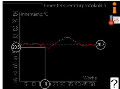
1. Drehen Sie das Wählrad so, dass der Ring auf der Welle mit der Wochennummer markiert wird.
