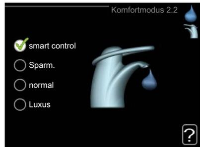
Der Unterschied zwischen den verfügbaren Modi besteht in der Brauchwassertemperatur. Bei einer höheren Temperatur steht mehr Brauchwasser zur Verfü-
