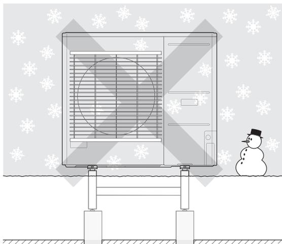
Не допускайте накопления снега, покрытия им решеток и дренажных отверстий на AMS 10.
