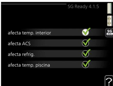
En el modo de bajo coste de «SG Ready» se define la temperatura de parada de la producción de ACS más alta posible en el modo de funcionamiento solo con compresor (el calentador de inmersión no se puede encender).
