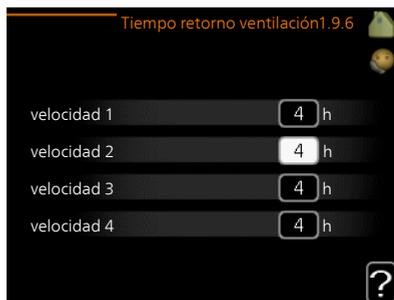
Aquí se selecciona el tiempo de retorno del cambio de velocidad temporal (velocidad 1-4) definido para la ventilación en el menú 1.2.
