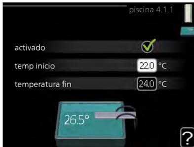
Permite seleccionar si el control de la piscina debe estar activo, entre qué temperaturas (de inicio y de paro) debe activarse la calefacción de la piscina y cuántos compresores deben ponerse en marcha simultáneamente.
