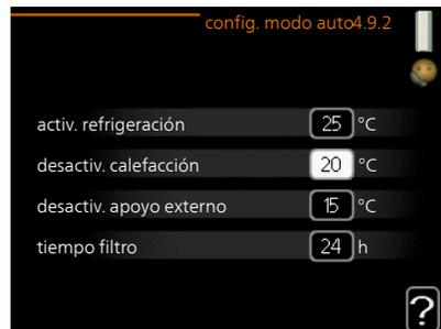
Cuando el modo de funcionamiento está en "auto", el módulo de control decide cuándo activar y desactivar el apoyo externo y la producción de calefacción, dependiendo de la temperatura exterior media. Si la bomba de calor tiene integrada la función de refrigeración y se ha activado en el menú, también podrá seleccionar la temperatura de activación de la refrigeración.
