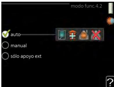
Normalmente, el modo de funcionamiento del módulo de control es "auto". También se puede seleccionar el modo "sólo apoyo ext", si solamente se utiliza un sistema de calor adicional, o bien "manual" y luego elegir las funciones autorizadas.
