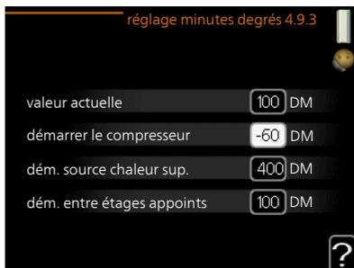
Les degrés minutes correspondent à une mesure du besoin actuel de chauffage dans l'habitation, et déterminent le moment où le compresseur démarre/s'arrête.
