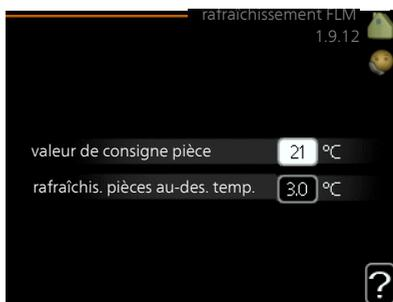
Lorsque vous avez activé rafraîchissement FLM dans le menu 5.3.1, configurez la température ambiante souhaitée dans ce menu. Sélectionnez également la température à laquelle le rafraîchissement doit démarrer.
