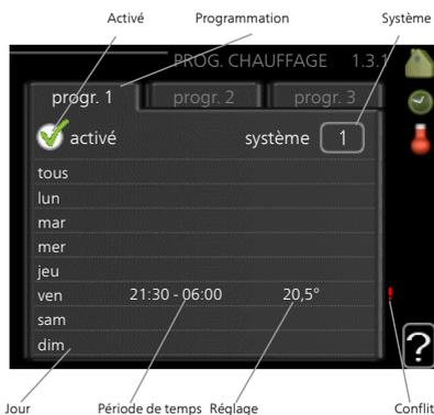
*Réglage* : permet de définir le décalage de la courbe de chauffage par rapport au menu 1.1 pendant la programmation. Si une sonde d'ambiance est installée, la température ambiante souhaitée est indiquée en °C.
