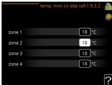
Dans le menu 1.9.3, vous sélectionnez chauffage ou rafraîchissement, dans le menu suivant (température de départ min. de chauffage/rafraîchissement) réglez la température minimum de la température de départ du système d'émission. Cela signifie que F1255PC ne calculera jamais une température inférieure à celle définie ici.
