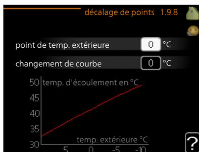
Sélectionnez ici un changement dans la loi d'eau à une certaine température extérieure. Augmenter d'un seul incrément suffit en général à modifier la température ambiante d'un degré mais dans certains cas plusieurs incréments sont nécessaires.
