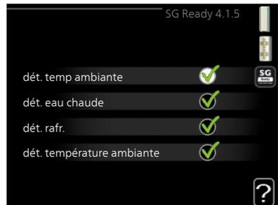
Lorsque « SG Ready » est en mode économique, le décalage parallèle de la température intérieure augmente de « +1 ». Si une sonde d'ambiance est installée et activée, la température ambiante souhaitée augmente de 1 °C.
