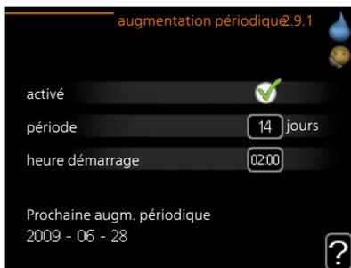
Pour éviter l'apparition de bactéries dans le préparateur ECS, le compresseur et
