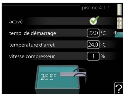
Sélectionnez si la commande de la piscine doit être activée et dans quelle plage de températures (température de démarrage et d'arrêt) la piscine doit être chauffée.
