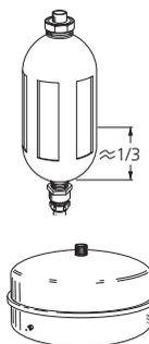
Sur certaines installations, la cuve de niveau est remplacée par un vase d'expansion (par exemple, lorsque la pompe à chaleur n'est pas située au point le plus élevé du système à eau glycolée) qui permet de vérifier la pression du système. La pression peut varier légèrement en fonction de la température du fluide. La pression ne doit pas être inférieure à 0,5 bar.
