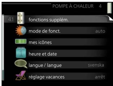
**mode de fonct.** Activation du mode de fonctionnement manuel ou automatique. L'information d'état indique le mode de fonctionnement sélectionné.
