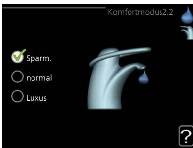
Der Unterschied zwischen den verfügbaren Modi besteht in der Brauchwassertemperatur. Bei einer höheren Temperatur steht mehr Brauchwasser zur Verfügung.
