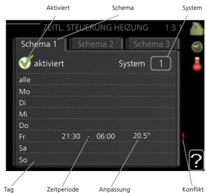
**Anpassung:** Hier legen Sie für das Zeitprogramm fest, wie sehr die Heizkurve im Vergleich zu Menü 1.1 geändert werden soll. Wenn ein Raumfühler installiert ist, wird die gewünschte Raumtemperatur in °C eingestellt.
