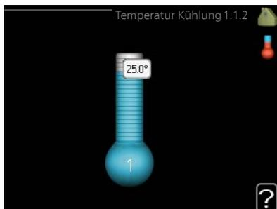
Der Wert auf dem Display wird als Temperatur in °C angezeigt, wenn das Klimatisierungssystem per Raumfühler gesteuert wird.
