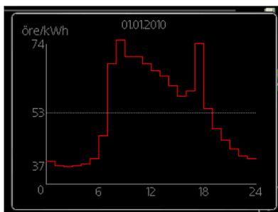
Im Menü Smart price adaption™ geben Sie an, in welchem Bereich sich die Wärmepumpe befindet und legen die Bedeutung des Strompreises fest. Je höher der Wert, desto größer ist die Bedeutung des Strompreises und desto höher fällt die mögliche Einsparung aus. Gleichzeitig steigt jedoch das Risiko für eine Beeinträchtigung des Komforts.
