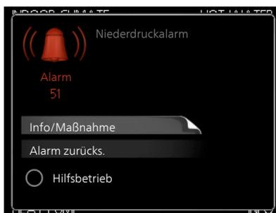
*Hilfsbetrieb* „Hilfsbetrieb“ ist ein Reservebetriebstyp. Demzufolge heizt die Wärmepumpe und bzw. oder erzeugt Brauchwasser, obwohl ein Problem vorliegt. Dabei kann es möglich sein, dass der Verdichter der Wärmepumpe nicht in Betrieb ist. In diesem Fall übernimmt die Elektroheizpatrone die Beheizung bzw. Brauchwasserbereitung.
