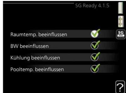
Im Überkapazitätsmodus von „SG Ready“ und im Kühlbetrieb wird die Parallelverschiebung für die Innentemperatur um „-1“ verringert. Ist ein Raumfühler installiert und aktiviert, wird stattdessen die gewünschte Raumtemperatur um 1 °C verringert.
