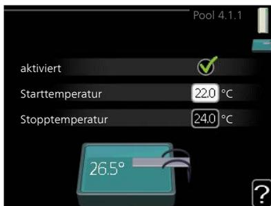
Hier legen Sie fest, ob die Poolsteuerung aktiviert sein soll und innerhalb welcher Temperaturgrenzen (Start- und Stopptemperatur) die Poolerwärmung stattfinden soll sowie wie viele Verdichter für diesen Pool gleichzeitig arbeiten dürfen.
