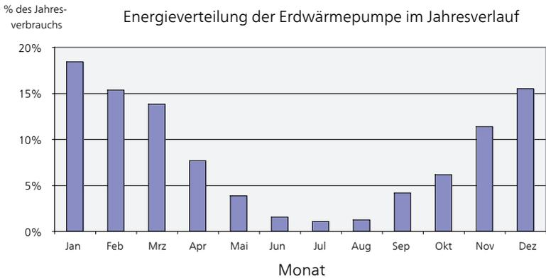
Das Diagramm stellt den Energieverbrauch dar, wenn sich die Anlage ausschließlich im Heizbetrieb befindet. Bei Nutzung des Kühlbetriebs kann sich der Energieverbrauch in der warmen Jahreszeit leicht erhöhen.
