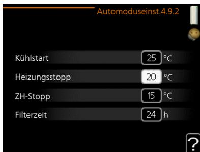
Wenn als Betriebsmodus "auto" eingestellt ist, bestimmt die Wärmepumpe ausgehend von der mittleren Außenlufttemperatur selbst, wann Start und Stopp von Zusatzheizung sowie Brauchwasserbereitung zulässig sind. Sie können ebenfalls die Starttemperatur für die Kühlung festlegen.
