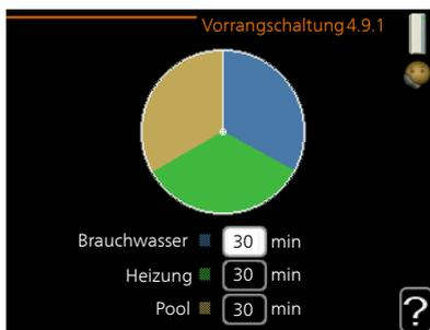
Hier legen Sie fest, wieviel Betriebszeit die Wärmepumpe für den jeweiligen Bedarf aufwenden soll, wenn mehr als ein Bedarf gleichzeitig vorliegt. Liegt nur ein Bedarf vor, wird dieser von der Wärmepumpe gedeckt.
