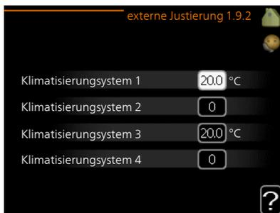
Durch Anbringen eines externen Anschlusses, z. B. Raumthermostat oder Schaltuhr, kann die Raumtemperatur bei der Beheizung vorübergehend oder periodisch erhöht oder verringert werden. Wenn der Anschluss eingeschaltet ist, wird die Parallelverschiebung der Heizkurve um die im Menü gewählte Stufenanzahl geändert. Wenn ein Raumfühler installiert und aktiviert ist, wird die gewünschte Raumtemperatur (°C) eingestellt.
