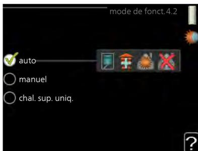
Le mode de fonctionnement du module de commande est généralement réglé sur « auto ». Il est également possible de régler le module de commande sur « chal. sup. uniq. » quand seul un appoint est utilisé, ou « manuel » puis sélectionnez les fonctions autorisées.
