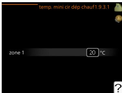
Dans le menu 1.9.3, vous sélectionnez chauffage ou rafraîchissement, dans le menu suivant (température de départ min. de chauffage/rafraîchissement) réglez la température minimum de la température de départ du système d'émission. Cela signifie que SMO 20 ne calculera jamais une température inférieure à celle définie ici.
