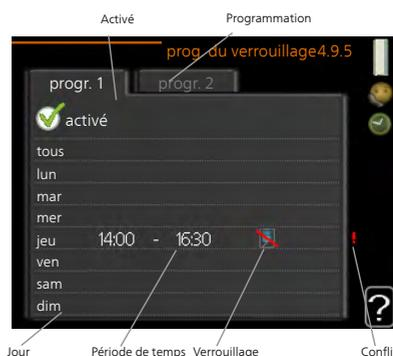
*Verrouillage* : permet de sélectionner ici le verrouillage souhaité.
