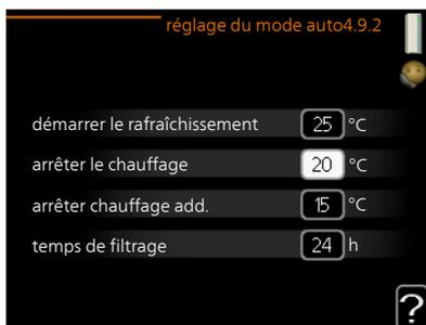
Lorsque le mode de fonctionnement est réglé sur « auto », le module commande définit quand le démarrage et l'arrêt de l'appoint et de la production de chaleur sont permis, selon la température extérieure moyenne. Si la pompe à chaleur est équipée d'une fonction de rafraîchissement intégrée et qu'elle est activée dans le menu, vous pouvez également sélectionner la température de démarrage du rafraîchissement.
