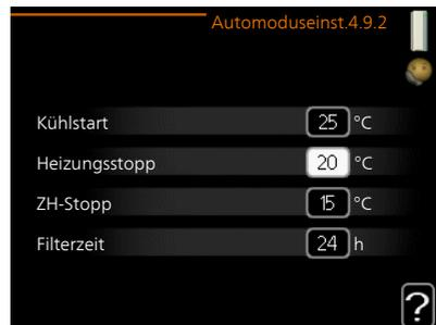
Wenn als Betriebsmodus „auto“ eingestellt ist, bestimmt das Regelgerät ausgehend von der mittleren Außenlufttemperatur selbst, wann Start und Stopp von Zusatzheizung sowie Brauchwasserbereitung zulässig sind. Wenn die Wärmepumpe über eine integrierte Kühlfunktion verfügt und diese im Menü aktiviert ist, können Sie ebenfalls die Starttemperatur für die Kühlung festlegen.
