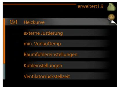
**Ventilatorrückstellzeit** Festlegung der Ventilatorrückstellzeit bei einer vorübergehenden Änderung der Ventilationsgeschwindigkeit.
