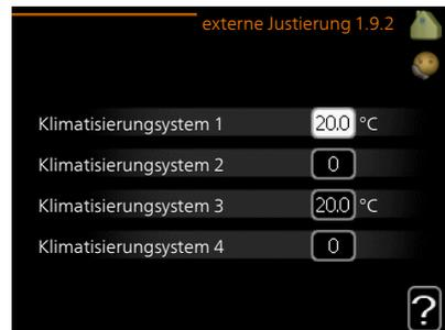
Durch Anbringen eines externen Anschlusses, z. B. Raumthermostat oder Schaltuhr, kann die Raumtemperatur bei der Beheizung vorübergehend oder periodisch erhöht oder verringert werden. Wenn der Anschluss eingeschaltet ist, wird die Parallelverschiebung der Heizkurve um die im Menü gewählte Stufenanzahl geändert. Wenn ein Raumfühler installiert und aktiviert ist, wird die gewünschte Raumtemperatur (°C) eingestellt.
