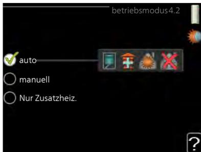
Der Betriebsmodus des Regelgeräts ist normalerweise auf "auto" eingestellt. Sie können das Regelgerät ebenfalls auf "Nur Zusatzheiz." stellen, wenn nur eine Zusatzheizung verwendet wird. Bei Auswahl von "manuell" können Sie die zugelassenen Funktionen selbst auswählen.
