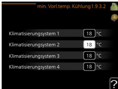
In Menü 1.9.3 wählen Sie Heizung oder Kühlung aus. Im nächsten Menü (min. Vorl.temp. Heizung/Kühlung) stellen Sie die minimale Vorlauftemperatur zum Klimatisierungssystem ein. Dementsprechend berechnet SMO 40 niemals eine Temperatur, die unter dem hier eingestellten Wert liegt.
