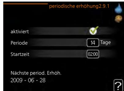
Um die Bildung von Bakterien im Brauchwasserspeicher zu verhindern, können Wärmepumpe und eventuelle Zusatzheizung gemeinsam in regelmäßigen Zeitabständen die Brauchwassertemperatur kurzzeitig erhöhen.
