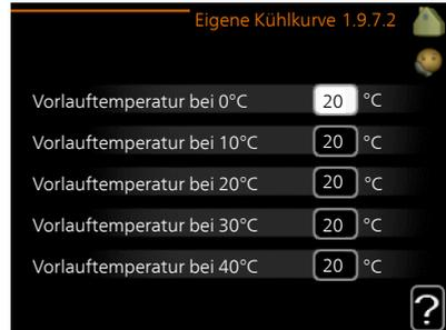
Hier können Sie bei speziellem Bedarf Ihre eigene Heiz- bzw. Kühlkurve erstellen, indem Sie die gewünschten Vorlauftemperaturen bei unterschiedlichen Außenlufttemperaturen vorgeben.
