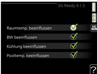
Wenn für „SG Ready“ die Option „Niedriger Preis“ eingestellt ist, wird die Stoptemperatur für das Brauchwasser bei ausschließlichem Verdichterbetrieb (Elektroheizpatrone nicht zulässig) so hoch wie möglich eingestellt.
