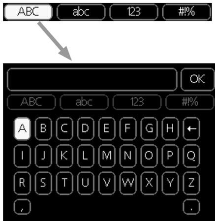
Je nach Menü stehen mehrere Zeichensätze zur Auswahl, zwischen denen per Wählerad umgeschaltet wird. Um zwischen den Zeichensätzen zu wechseln, drücken Sie die Zurück-Taste. Wenn für ein Menü nur ein Zeichensatz verfügbar ist, erscheint die Tastatur direkt.
