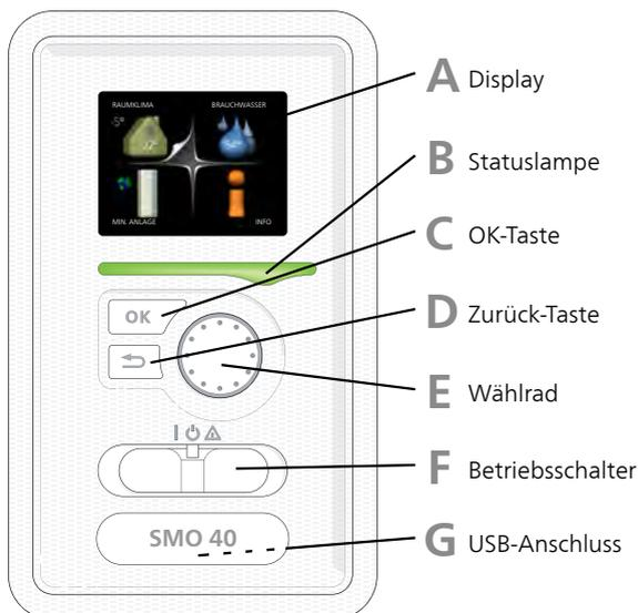
Hinter der Tür des Regelgeräts befindet sich ein Bedienfeld, das zur Kommunikation mit SMO 40 verwendet wird. Hier bestehen folgende Möglichkeiten:
