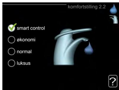
Forskjellen mellom de valgbare stillingen er temperaturen på tappevarmtvannet. Høyere temperatur gjør at varmtvannet holder lengre.
