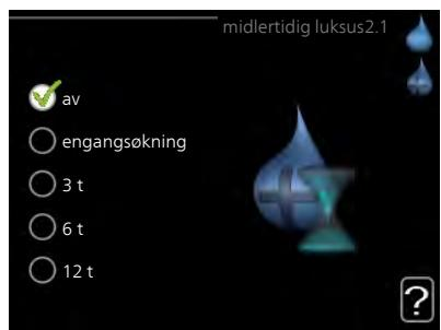
Ved midlertidig økt varmtvannsbehov kan du fra denne menyen velge å øke varmtvannstemperaturen til en luksusstillingen under valgbar tid.
