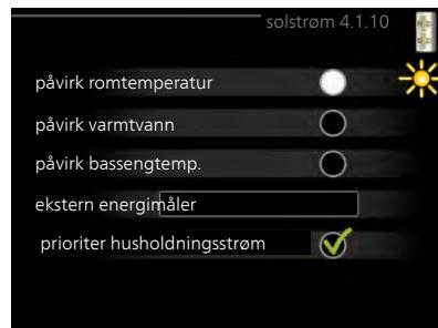
Her stiller du inn hvilken del av anlegget (romtemperatur, varmtvannstemperatur, bassengtemperatur) som skal påvirkes av solstrømoverskuddet.
