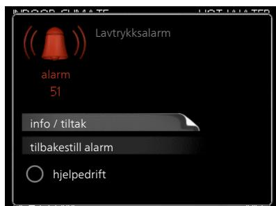
Ved alarm med rød statuslampe har det oppstått en driftsforstyrrelse som varmepumpen og/eller styremodulen ikke kan rette opp selv. Ved å vri på betjeningsrattet og trykke på OK-knappen i displayet kan du se alarmtypen samt tilbakestille alarmen. Du kan også velge å sette anlegget i hjelpedrift.
