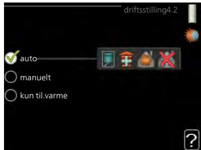
Styremodulens driftsstilling er normalt innstilt i "auto". Du har også mulighet til å sette styremodulen på "kun til.varme" når bare tillegg benyttes, eller "manuelt" og selv velge hvilke funksjoner som skal tillates.
