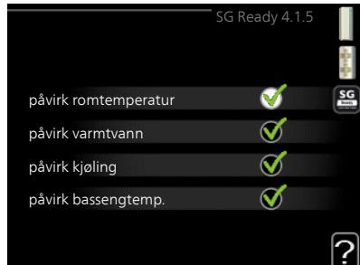
Ved lavprisstilling på "SG Ready" økes parallelfforskyvningen for innetemperaturen med "+1". Hvis romføler er installert og aktivert, økes i stedet ønsket romtemperatur med 1 °C.
