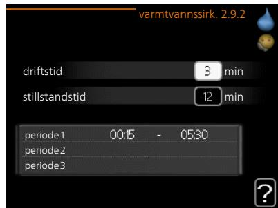
Her kan du stille inn varmtvannssirkulasjon i opptil tre perioder per døgn. I de innstilte periodene kommer varmtvannssirkulasjonspumpen til å gå i henhold til innstillingene ovenfor.
