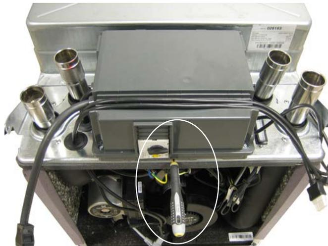
**3** Lösen Sie 12 Schrauben. (Die gestrichelte Linie zeigt an, dass die Schraube von dieser Seite nicht sichtbar ist.)
