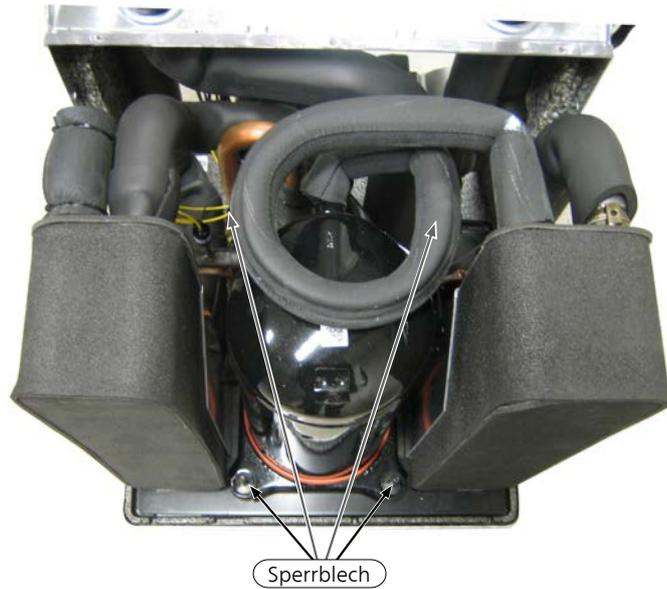
**12** Leeren Sie den Kältekreis und stellen Sie vor dem Fortsetzen der Arbeiten sicher, dass kein Kältemittel mehr vorhanden ist. Entfernen Sie eine eventuelle Rohrisolierung über dem Heißgasrohr.
