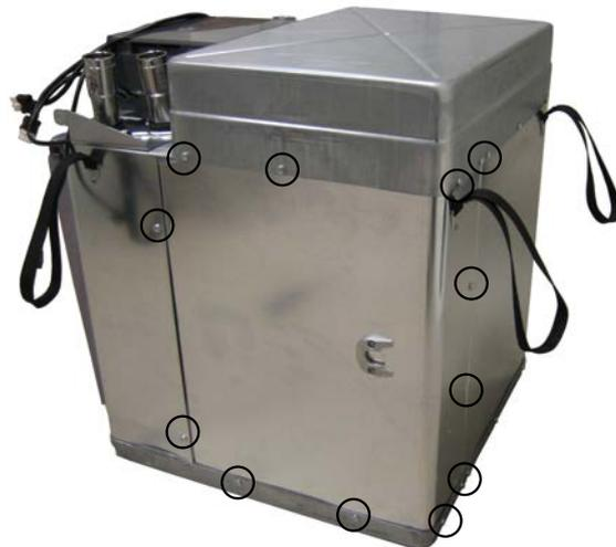
**7** Leeren Sie den Kältekreis und stellen Sie vor dem Fortsetzen der Arbeiten sicher, dass kein Kältemittel mehr vorhanden ist. Entfernen Sie eine eventuelle Isolierung.
