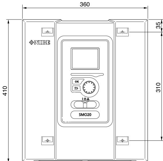
Bruk alle festepunkt og monter SMO 20 i stående stilling mot vegg uten at noen deler av styremodulen stikker utenfor kanten av veggen.
